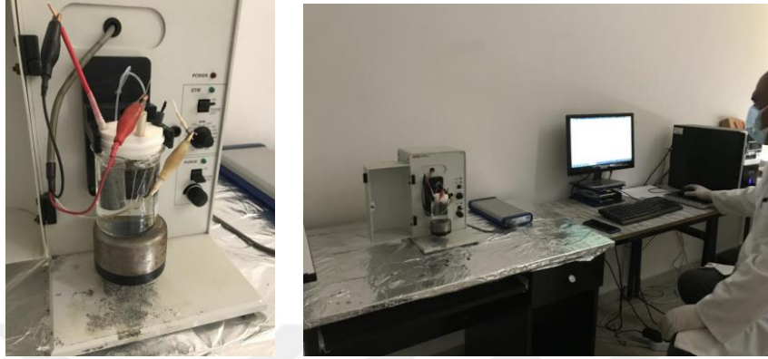
Şekil 2.4 Elektrokimyasal hücre ve potansiyostat cihazı ve yazılımı
