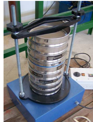
Resim 4.13. Toz eleme makinesi ve elekler [40]
