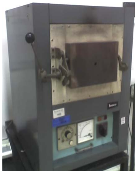
Resim 4.3. Deneylerde kullanılan genel maksatlı fırın [40]
