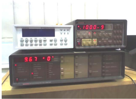
Resim 4.12. Direnç ölçümlerinde kullanılan KEITHLEY-619 tipi elektrometre [40]
