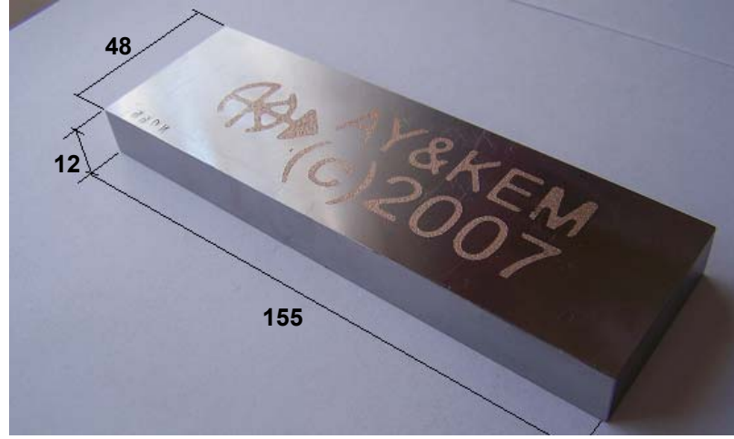
Resim 17.4. İşleme sonrası elde edilen ürün ve boyutları [40]
