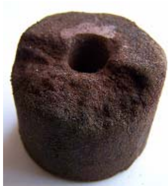
Resim 5.2. Aşırı dolgu malzemesi yüklemesi sonucu elektrotta meydana gelen tozlaşma ve deformasyonlar [40]
