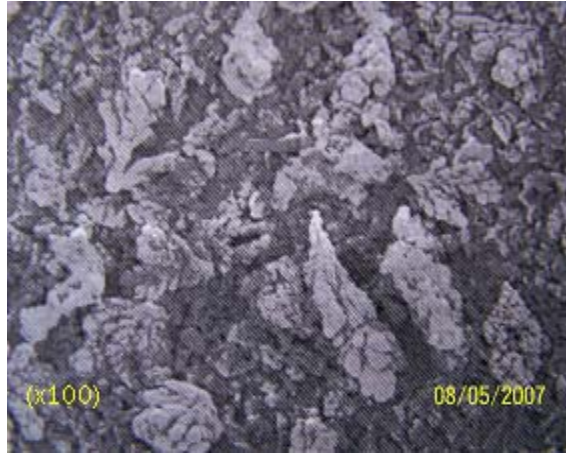
Resim 4.1. Deneylerde kullanılan dendritik bakır tozu (x100 ölçek)
