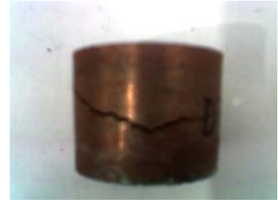
Resim 5.5. Pişirme sonucu çatlamış elektrot [40]
