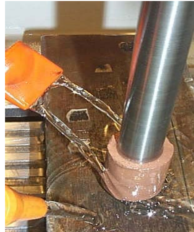
Resim 4.6. Deneylerde kullanılan Polyester-Bakır kompozit elektrot ve dielektrik uygulama şekli [40]
