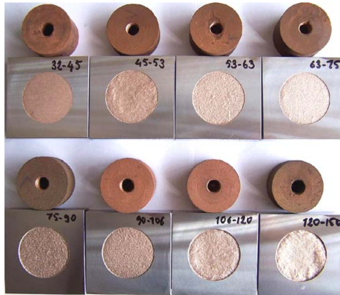
Resim 5.7. Homojen dağılımlı tane büyüklüğüne sahip bakır tozundan üretilmiş elektrotlara ait elektrot-iş parçası görüntüleri [40]
