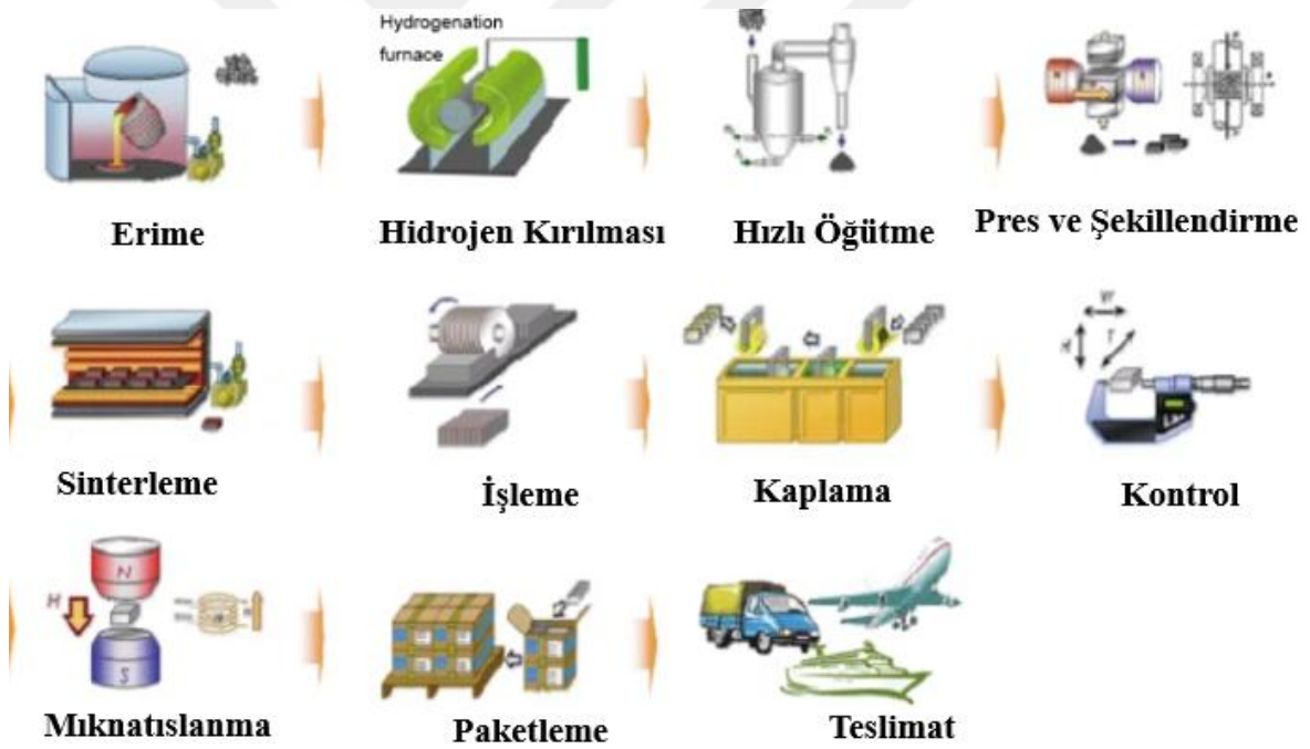
Şekil 2.1. NdFeB mıknatısların üretim süreci
