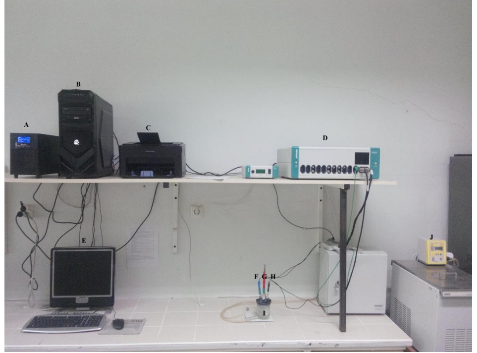
Şekil 2.1 Ölçüm Sistemi [ A: Güç kaynağı, B: Bilgisayar, C: Yazıcı, D: Autolab Potansiyostat/Galvanostat/PGSTAT 302 (FRA 2-220, ECD-220 modülleri), E: Monitör, F,G,H: Üçlü elektrot sistemi sırasıyla Ag/AgCl çift cidarlı referans elektrot; Çalışma elektrotu; Yardımcı elektrot, I: Çift cidarlı reaksiyon hücresi, J: Termostat ]
