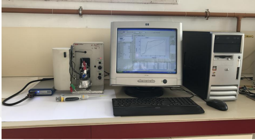
Şekil 3.2. Elektrokimyasal ölçümlerde kullanılan elektroanalizör ve elektrot sistemi
