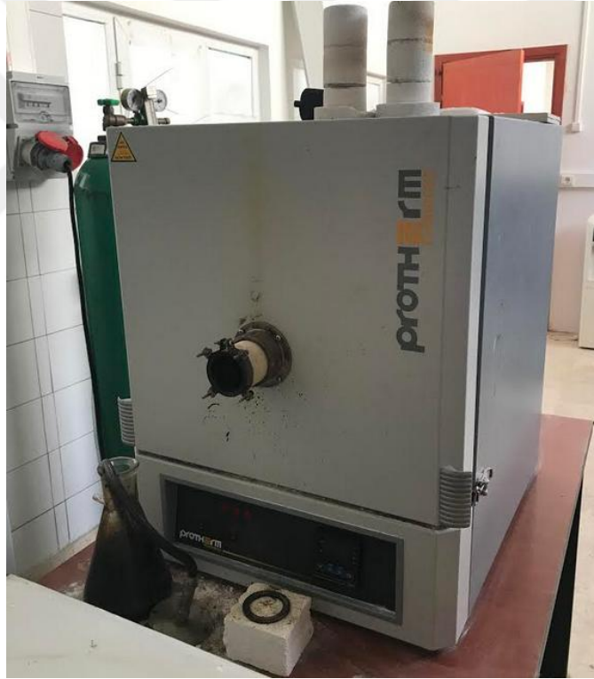
Şekil 3.6. Karbonizasyon işlemlerinde kullanılan kamaralı tüp fırın
