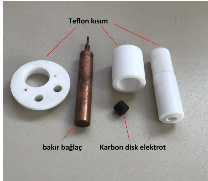
Şekil 3.8. Karbonize edilmiş disk elektrotların çalışma elektrotu olarak kullanıldığı teflon sistem
