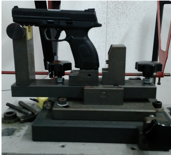
Şekil 2.26 Dağılım Test Atış Düzeneği ve Tabanca
