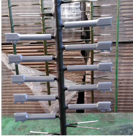
Şekil 2.13 Kaplama Öncesinde Namluların Aparata Dizilimi
