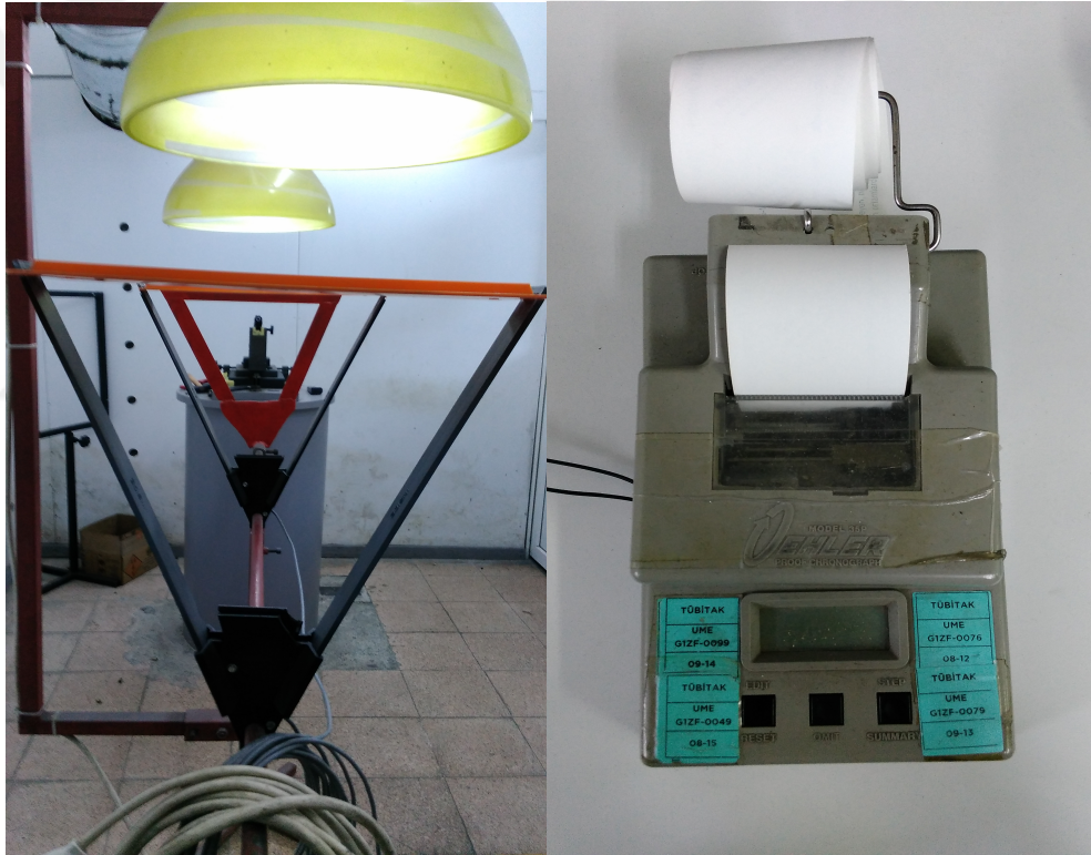
Şekil 2.20 Namlu Çıkış Hızı Ölçüm Cihazı Düzeneği
