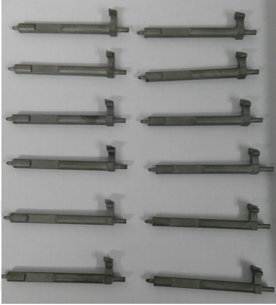
Şekil 2.17 Sert Krom Kaplama Öncesi MC 28 SA Ateşleme İğnesi Numuneleri
