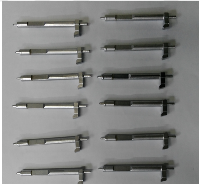
Şekil 2.18 Sert Krom Kaplama İşlemi Uygulanmış Numune İğneler
