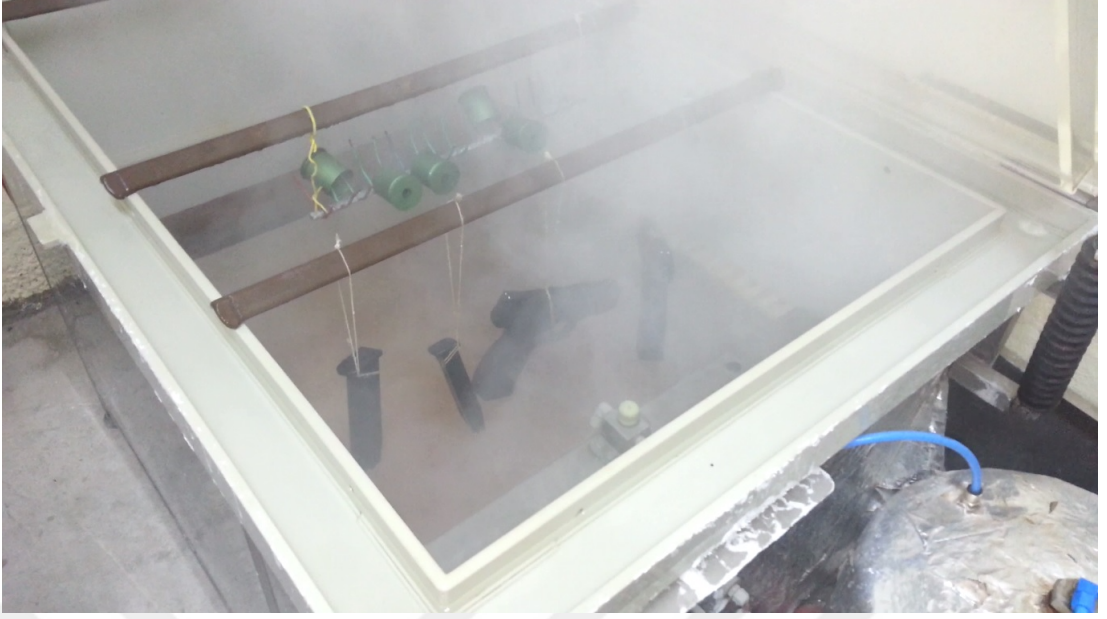
Şekil 2.27 Tuz Sisi Test Düzeneği
