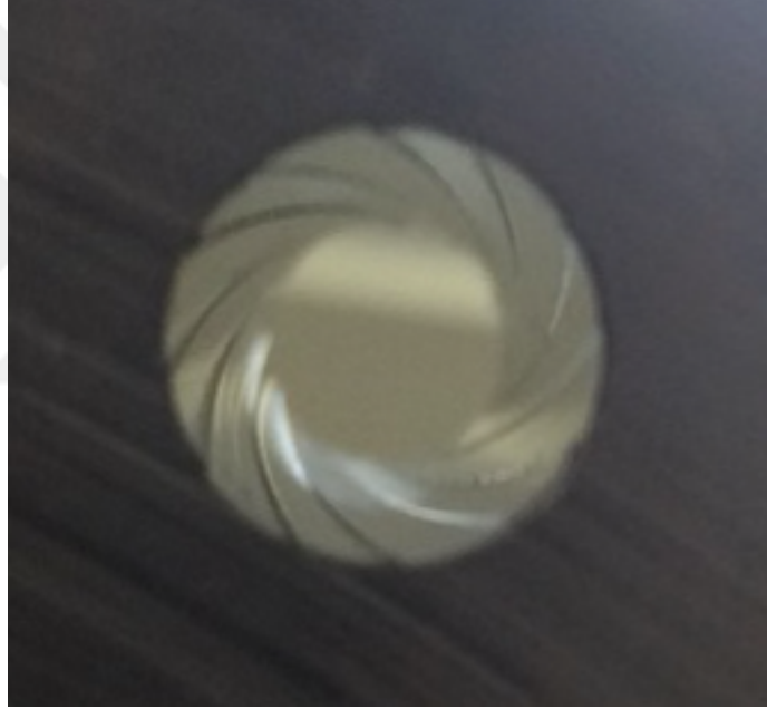
Şekil 2.29 Krom Kaplanan Namlunun Yiv-Set Çapı Mukavemet Testi Sonrasında Değişmemiştir
