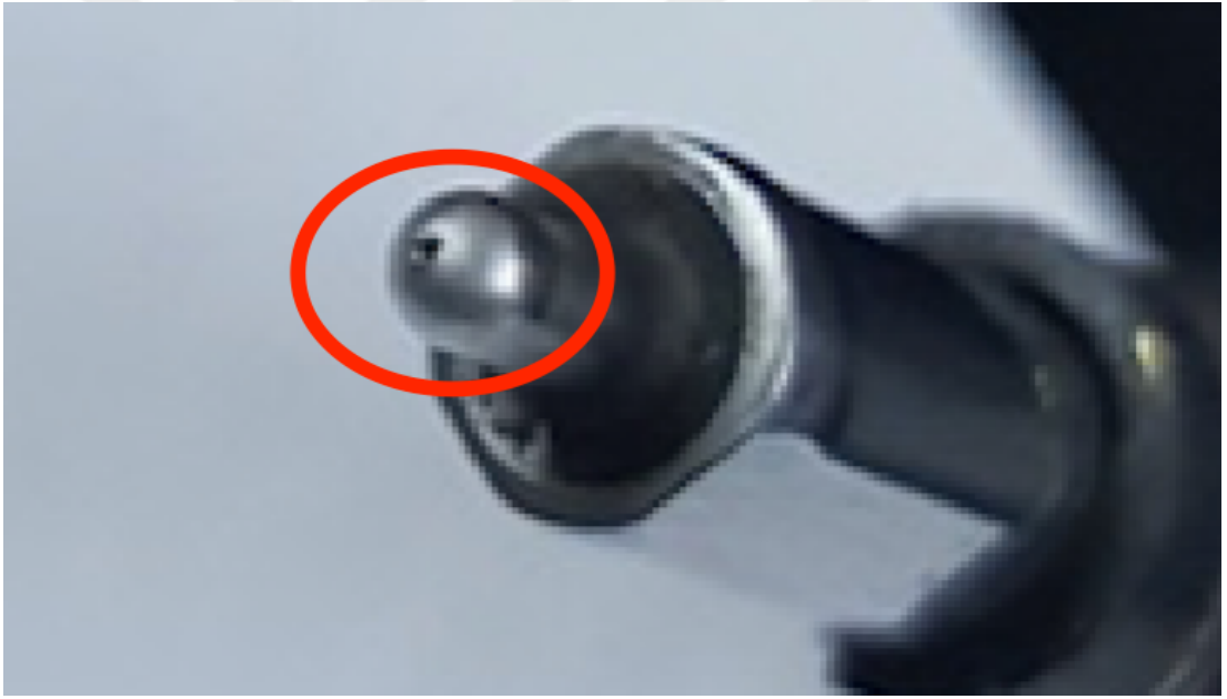
Şekil 4.8 İğne Ucunda Kraterleşme Oluşumu (Sert Krom Kaplanmayan İğne)
