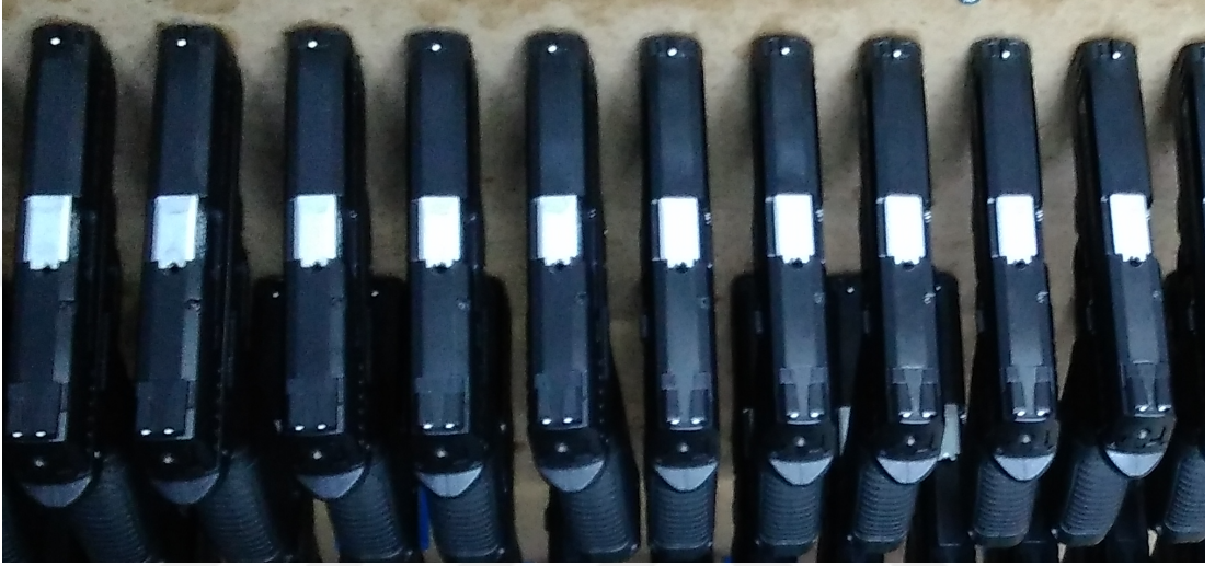
Şekil 2.25 Namluları Ve Ateşleme İğneleri Krom Kaplanmış Olan MC 28 SA Model Tabancalar
