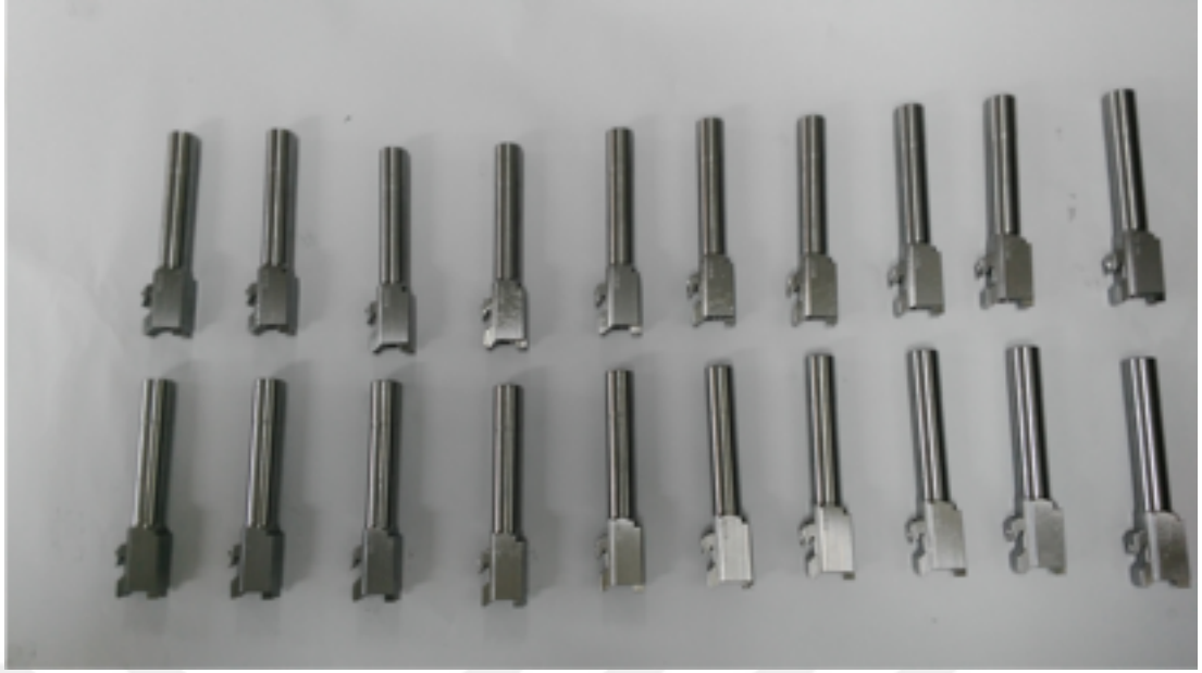
Şekil 2.11 Sert Krom Kaplama Öncesinde 20 Adet Tesviyesi Yapılmış MC 28 SA Tabanca Namluları
