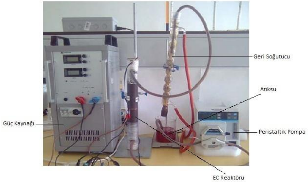
Şekil 7.1. Reaktif kırmızı boyarmaddesi ile yapılan deneylerde kullanılan düzenek
