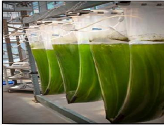
Şekil 2.8. Geniş torbalarda üretim [75]
