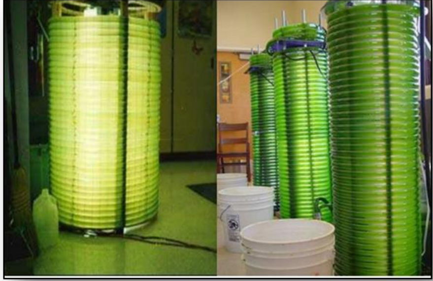
Şekil 2.12. Biocoil tip fotobiyoreaktör [75]
