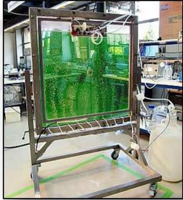
Şekil 2.11. Cam tip düz plaka fotobiyoreaktör [75]
