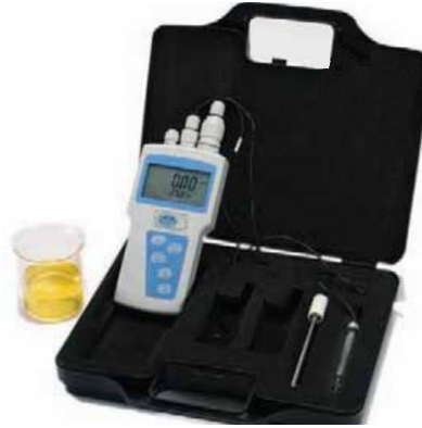
Şekil 7. 13. J.P. Selecta (CD-2004) portatif elektrik iletkenliği ölçüm aleti (JP Selecta S.A, 2014)
