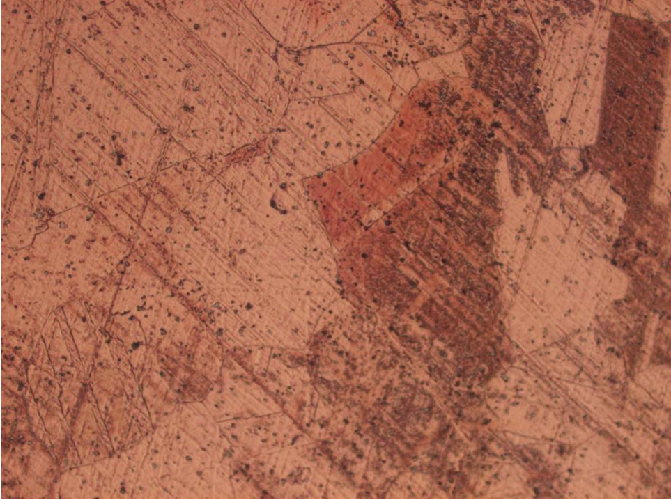
500 0 C de 4 saat Yaşlandırılmış CuCr1Zr alaşımı 20x büyütme
