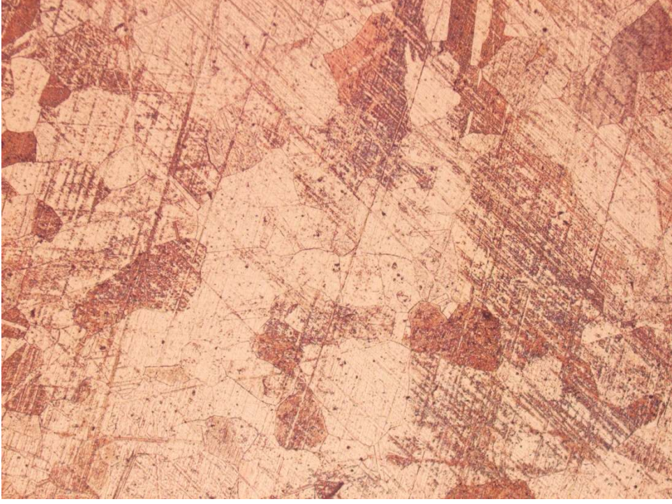
500 0 C de 4 saat Yaşlandırılmış CuCr1Zr alaşımı 10x büyütme
