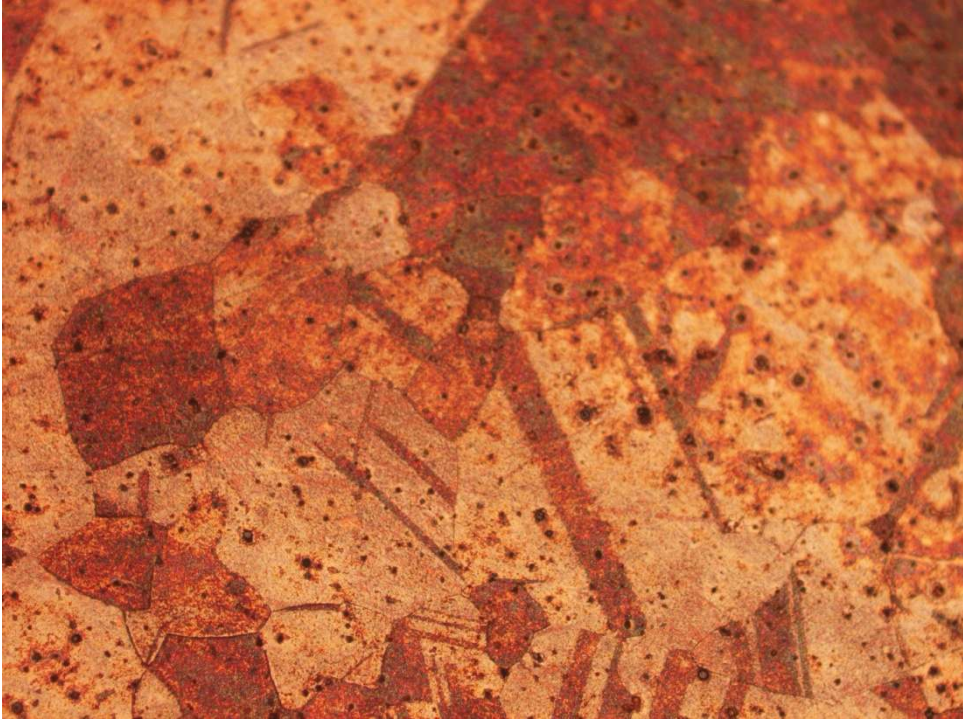
500 0 C de 2 saat Yaşlandırılmış CuCr1Zr Alaşımı 20x büyütme
