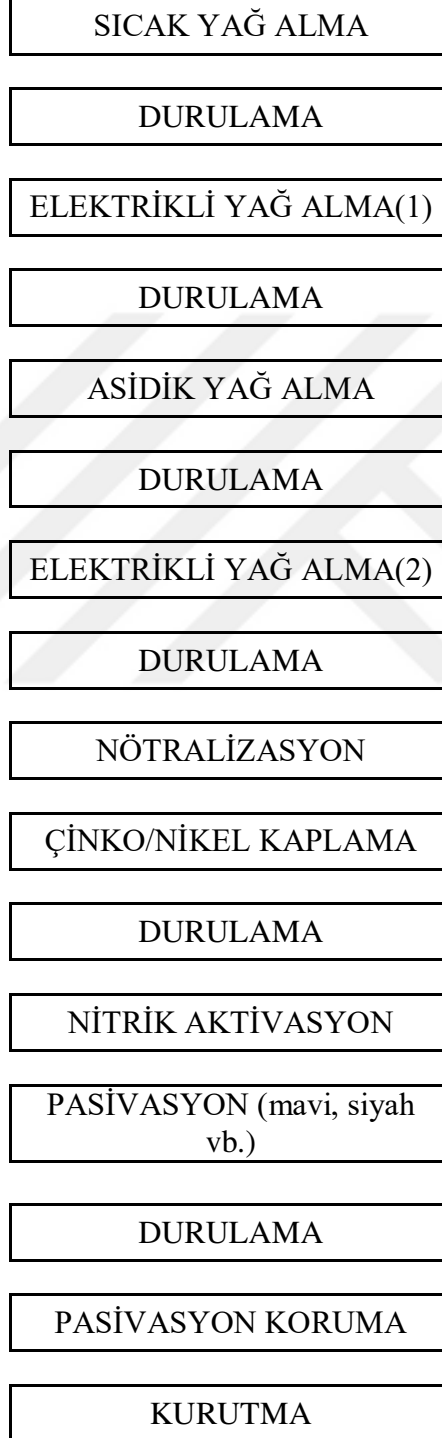
Şekil 2.5. Genel Bir Çinko/Nikel Kaplama Prosesinde İş Akış Şeması
