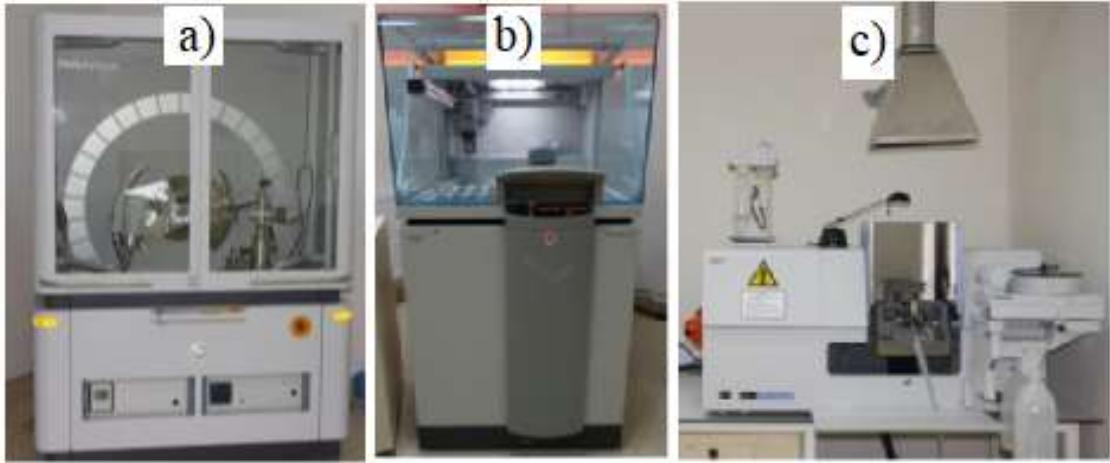
Şekil 7. 4. Numunelerin karakterizasyonunda kullanılan cihazlar ( a: HT-XRD, b: WD-XRF, c: AAS )
