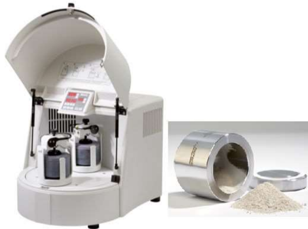
Şekil 7.5. Deneylerde kullanılan gezegensel değirmen ve çelik hazne
