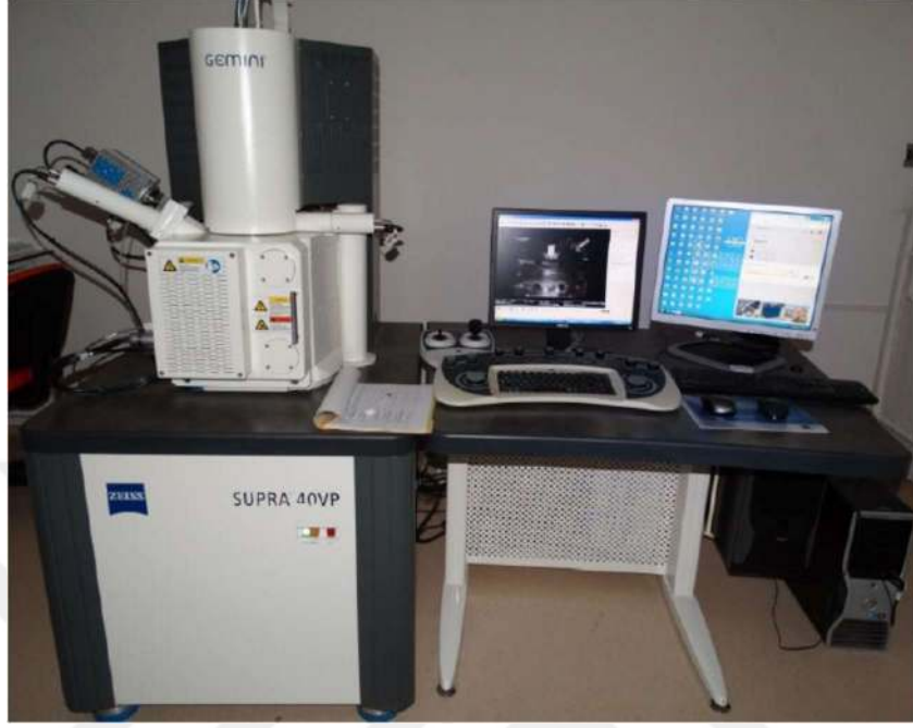
Şekil 7.6. Mikroyapının incelenmesinde kullanılan SEM cihazı
