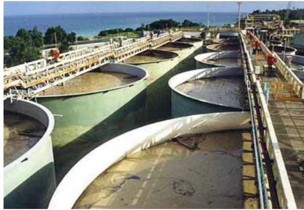
Şekil 4.3. Karıştırma Liçi İçin Kullanılan Liç Tankları
