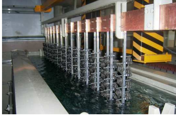
Şekil 6.2 Sert krom kaplamanın gerçekleştirildiği banyonun görüntüsü
