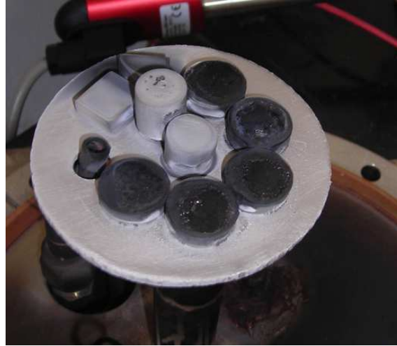
Şekil 6.5 Numunelerin yerleştirildiği tablanın, numunelerle beraber plazma nitrürleme işleminden sonraki görüntüsü
