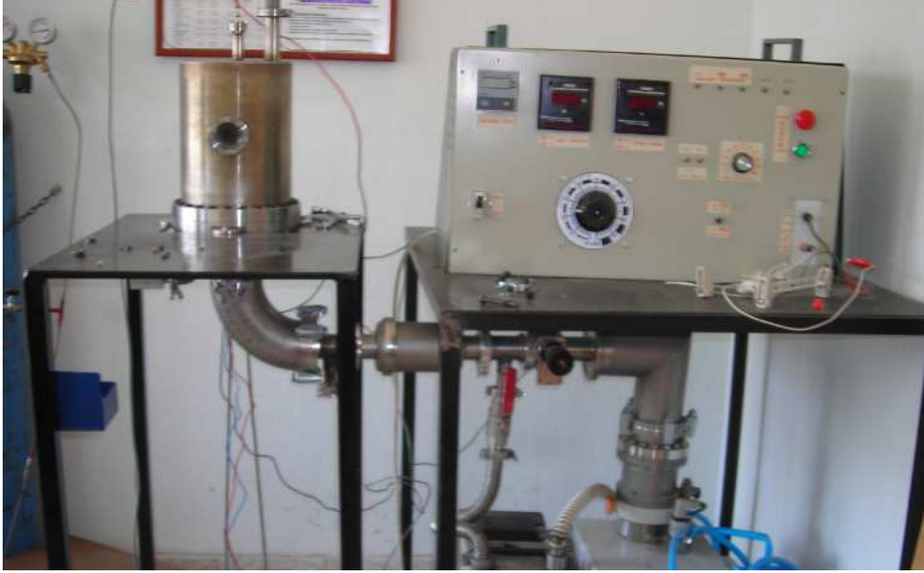
Şekil 6.6 Plazma nitrürleme işleminin yapıldığı fırın ve güç kaynağının görüntüsü
