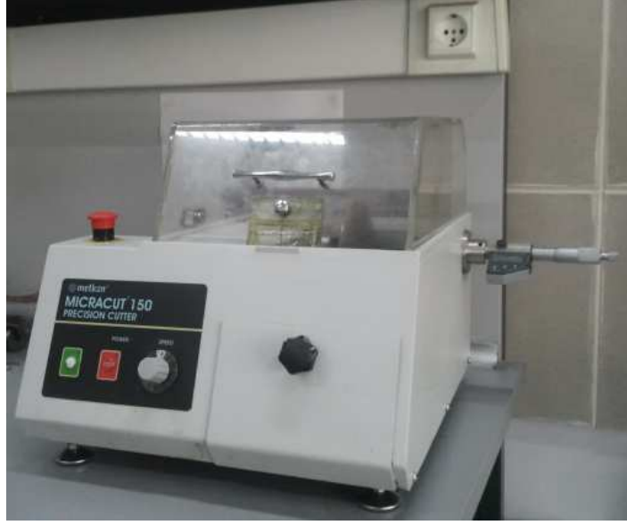
Şekil 6.10 Metkon Micracut 150 marka hassas kesme cihazı
