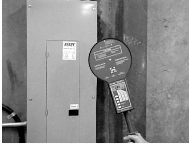
Şekil 6.3 Elektrik ve magnetik alan ölçümü
