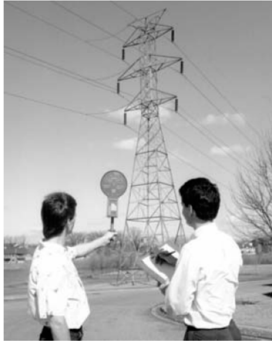
Şekil 6.2 Enerji iletim hattında alan ölçümü
