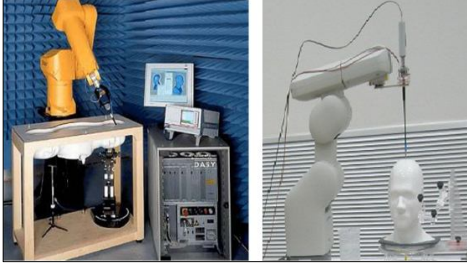
Şekil 2.9. SAR değerinin insan modeli robot üzerinde ölçümü
