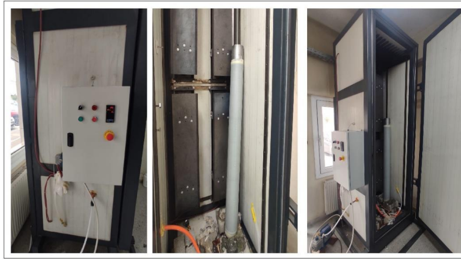
Şekil 57. PLC kontrollü ısıtma fırınında polimer gövdenin üretim süreci
