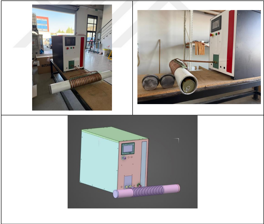
Şekil 61. Elektromanyetik indüksiyon sisteminin modelleme ve üretilen nihai halı
