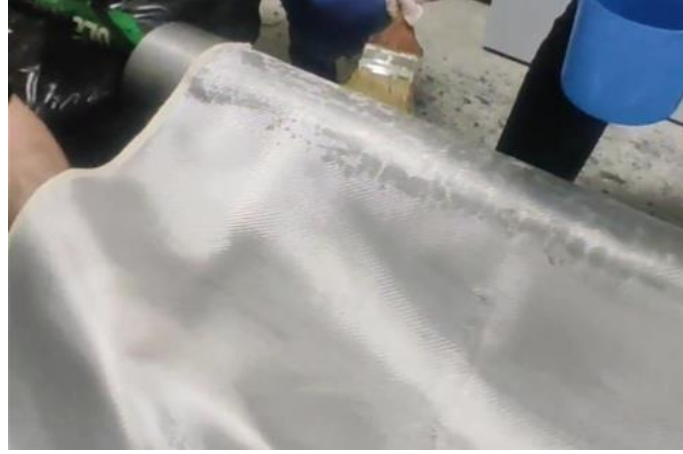
Şekil 56. Cam elyaf takviyesinin çelik kalıp üzerine epoksi matris ile uygulanması
