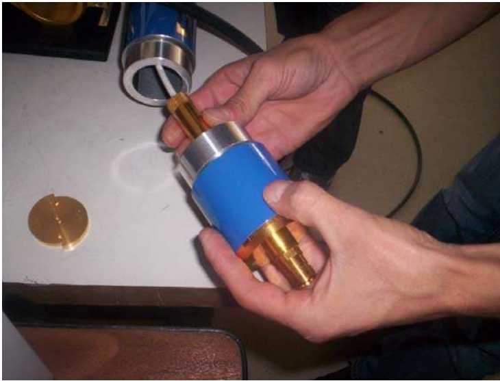
Resim 6.23. Konnektörlerin iç içe geçirilmesi
