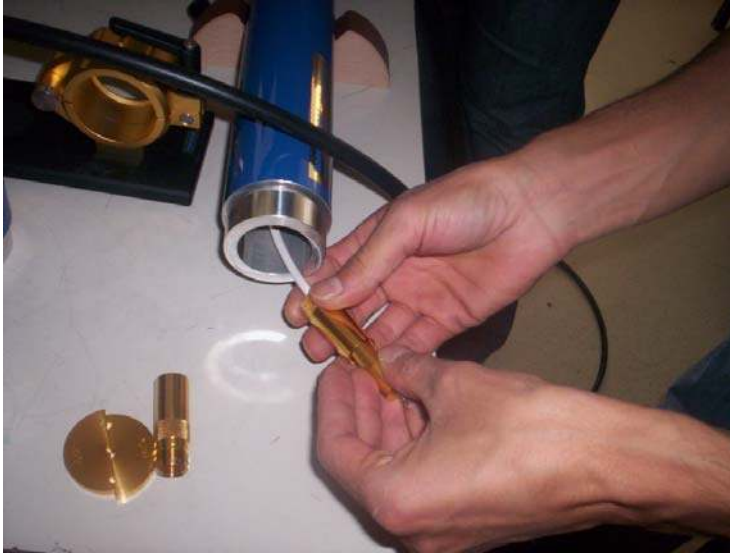
Resim 6.22. Tüpün sinyal ucunun hazırlanması
