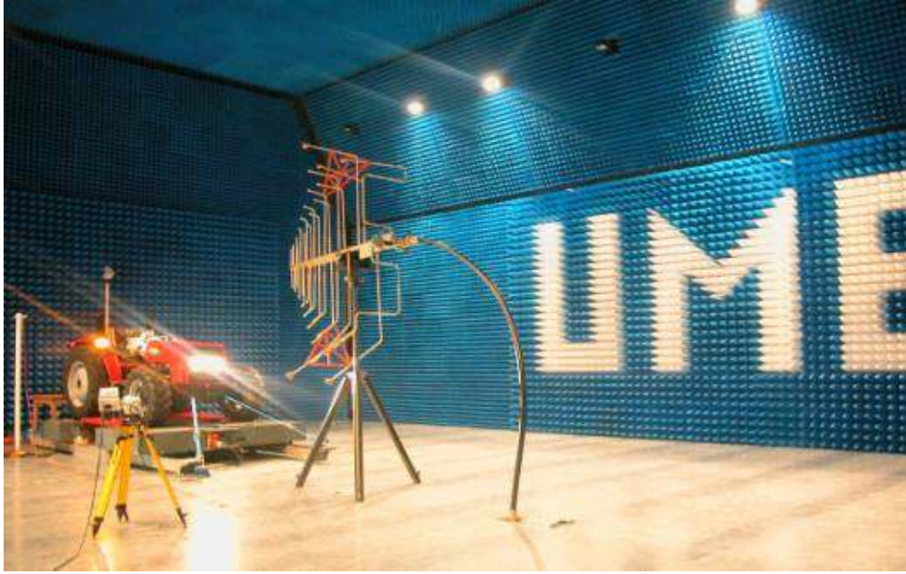
Resim 5.11. Yansız odada yapılan traktörün ışınlama bağımsızlık testi
