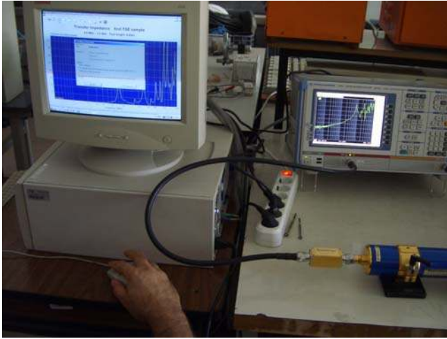
Resim 6.17. WinComet programı ile düzeneğin ölçülmesi
