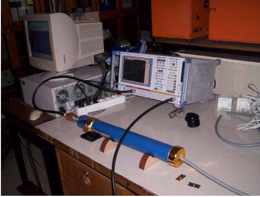
Resim 6.14. Test düzeneğinin sinyal üreticisine bağlanması
