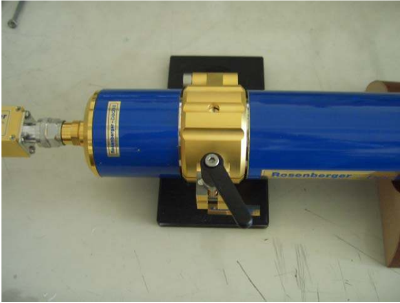
Resim 6.10. Tüpün bir ucunun bağlantısının en son vidalama işlemi ile tamamlanması
