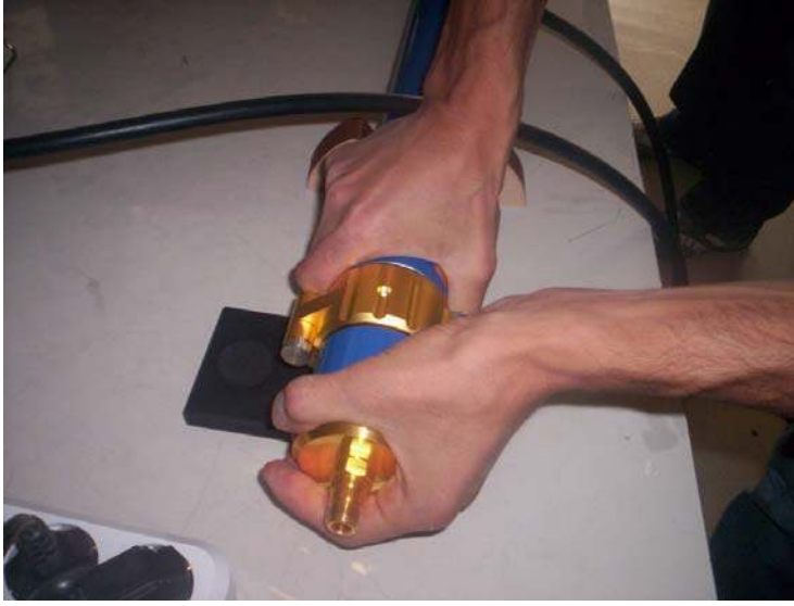
Resim 6.24. Ekranlama kutusunun yerine yerleştirilmesi
