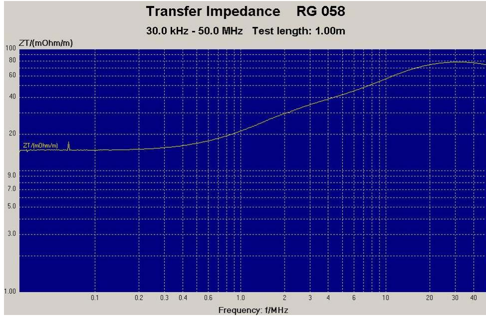
Şekil 6.23 RG-058 kablosu-üç eksenli metod kullanılarak ölçülmesi sonucu elde edilen frekans-transfer empedansı değişimi
