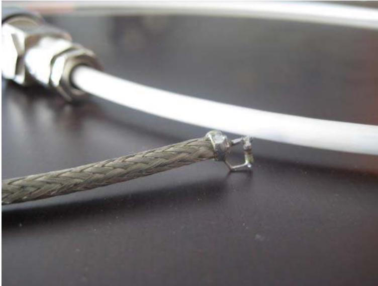
Resim 6.19. Kablo numunesinin bir ucunun deney hazırlığı için lehimlenmiş ucu
