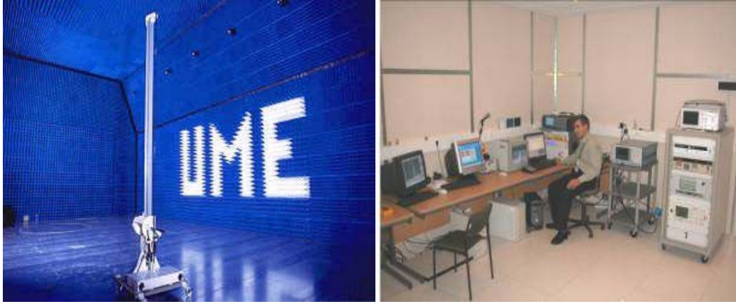
Resim 5.10. Yarı yansız odanın iç görünüşü ve YYO kontrol odası
