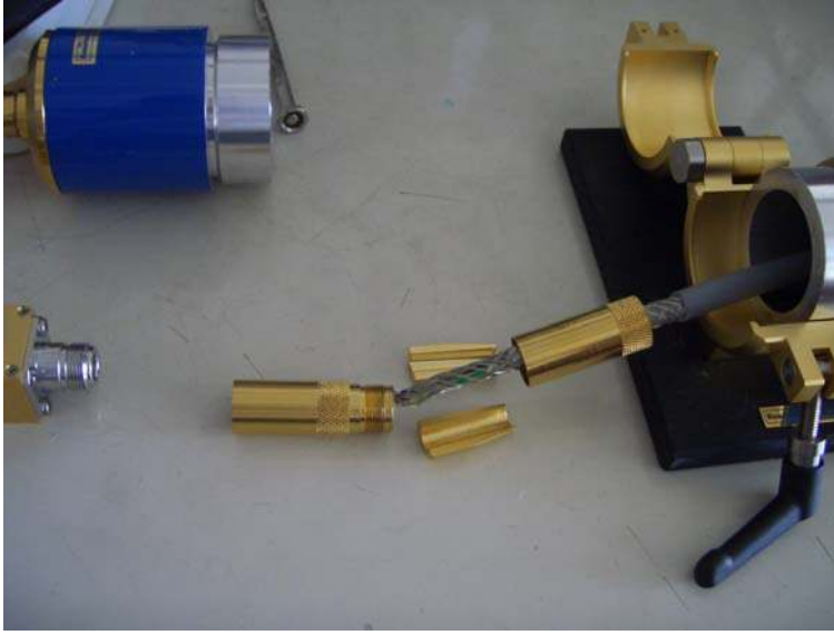
Resim 6.6. Uygun konnektörlerin seçilmesi ve bağlanması
