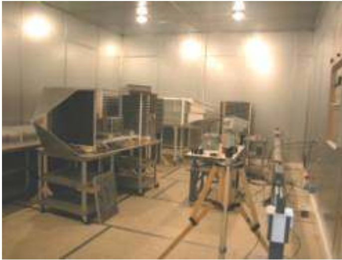
Resim 5.14. Ekranlı odada (4) bulunan iletimle bağışıklık test ve ölçüm düzenekleri
