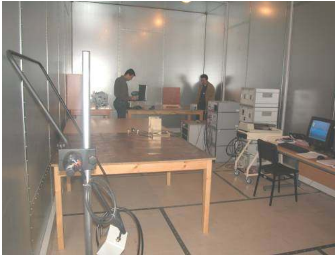
Resim 5.13. Ekranlı oda-2 test ve ölçüm düzenekleri
