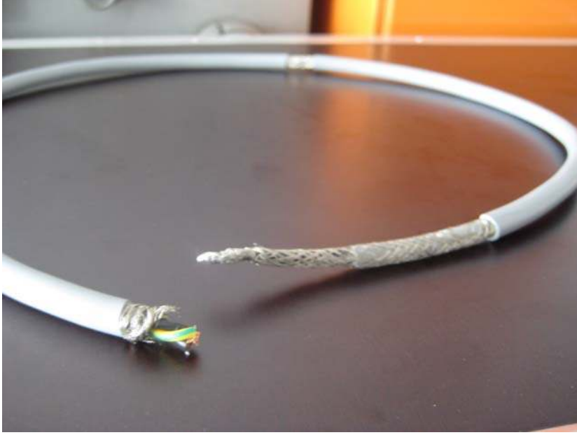
Resim 6.5. H05 VVC4 V5 – K tipi kablo numunesi
