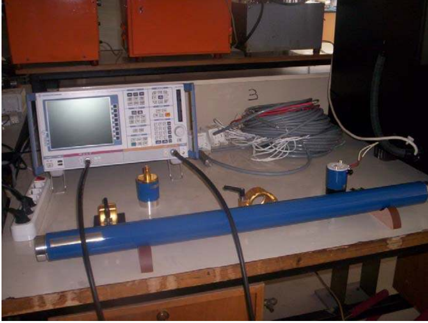
Resim 6.13. Kalibrasyon işleminin yapılması
