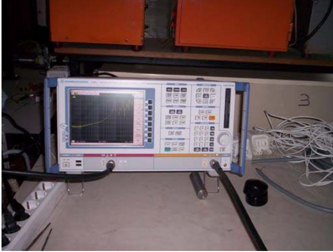
Resim 6.16. Tüpün uçlarının Network analizöre bağlanması
