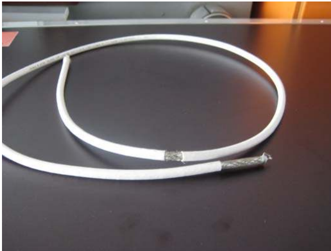
Resim 6.28. TELASS 0.7/4.7 VPE tipi kablo için kablo numunesi
