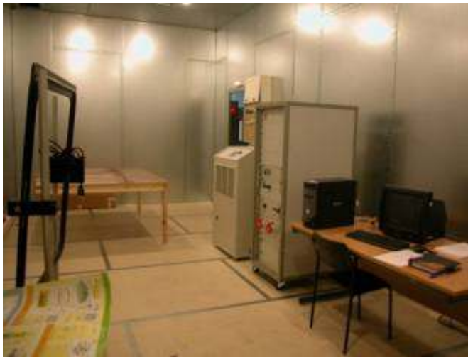
Resim 5.12. Ekranlı Oda-1 (Güç Kalitesi) test ve ölçüm düzenekleri
