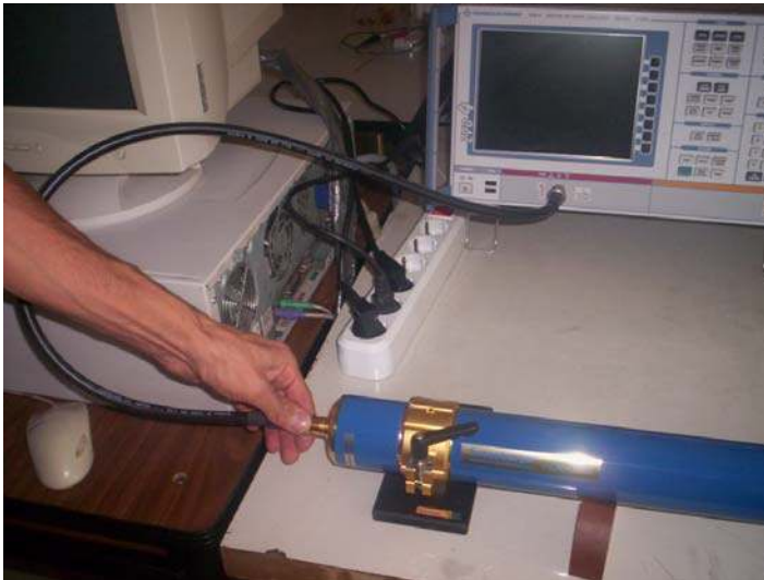
Resim 6.25. Analizörün sinyal üretici ucunun tüpe takılması
