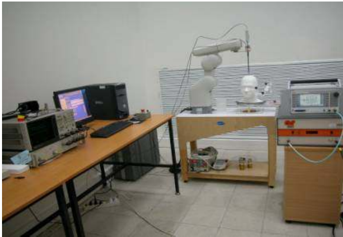
Resim 5.15. SAR Ölçüm düzeneği
