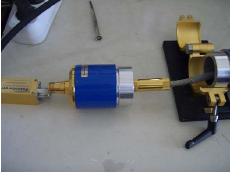
Resim 6.7. Ekranlama kutusunun vidalanması
