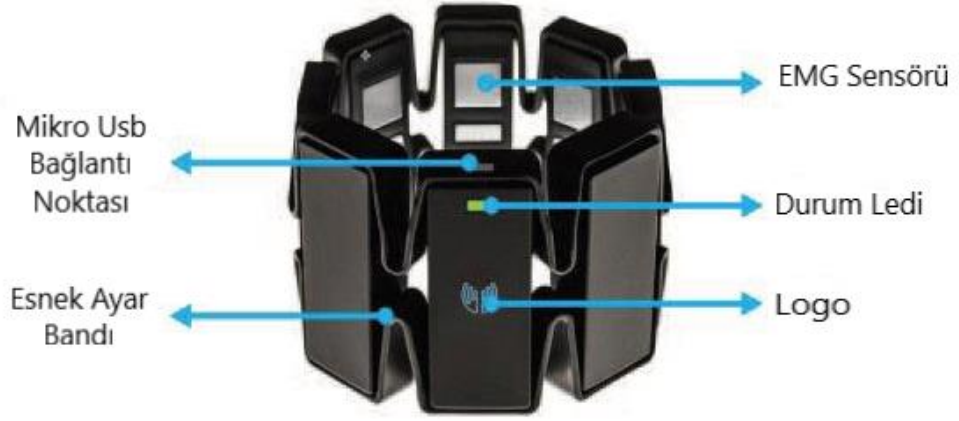
Şekil 3.1. MYO Kol Bandı Üzerindeki Özellikler
