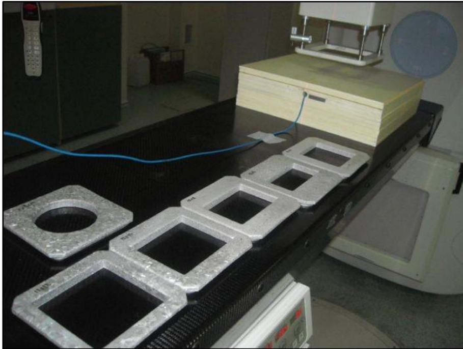
Şekil 9. Blok kesiciyle kesilip oluşturulan farklı boyutlardaki Cerrobend bloklar.
