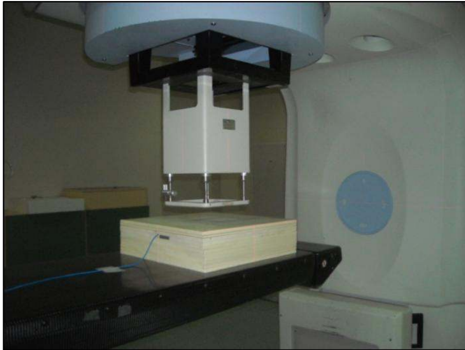
Şekil 14. Katı su fantomu ölçümleri için deney düzeneği.
