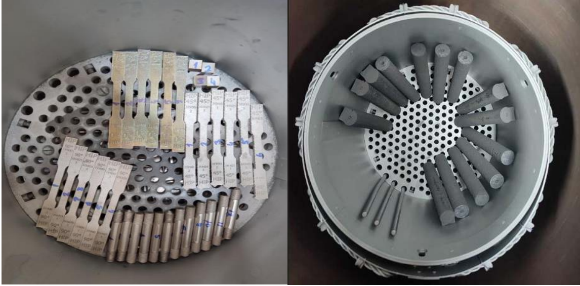
Şekil 19 Quintus Marka HIP ekipmanı haznesi içerisindeki test kuponlarının görseli.
