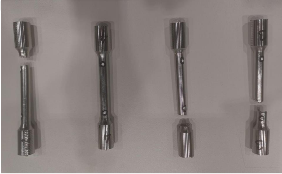
Şekil 35 P1 ve P2 Eİ numunelerinin çekme testinde kopan bazı görüntüleri
