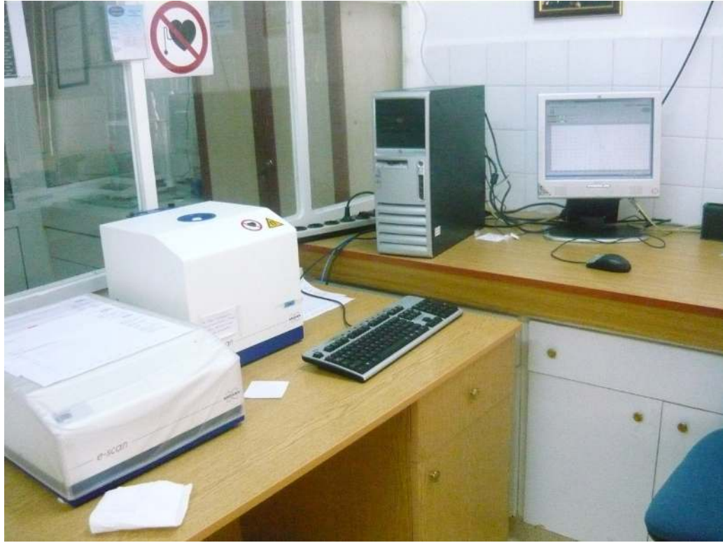
Şekil 5.14 ESR deney çalışmalarının gerçekleştirildiği e-scan ESR spektrometresi.
