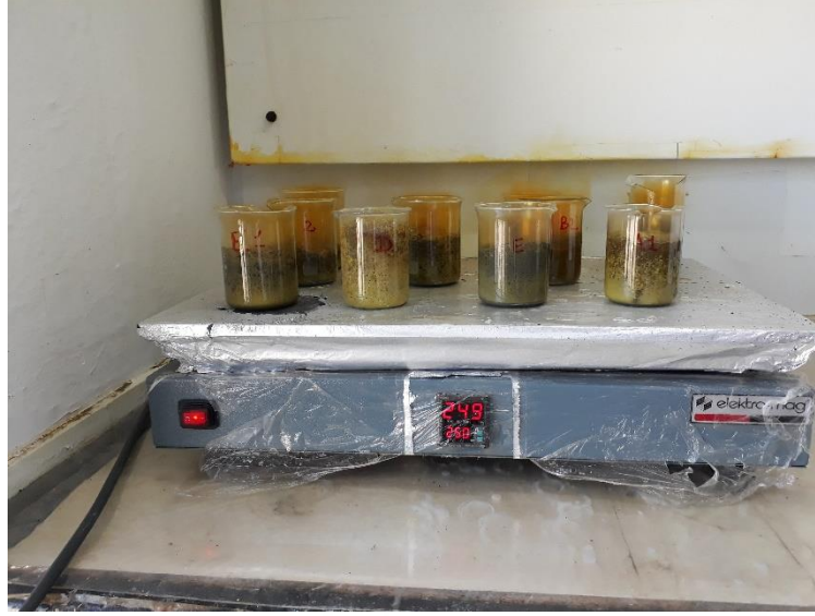
Şekil 28. Metalleri çözündürmek için kullanılan ısıtma plakası
