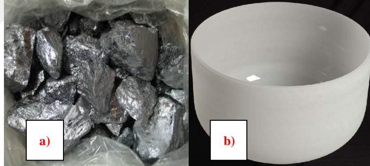
Şekil 3.1 Si ingot üretimi sarf maddeleri, a) % 99,999 saflıkta çok kristalin Si, b) Kuvars pota (Kişisel arşiv, 2017)
