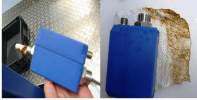
Şekil 3.4 Cz sistemi soğutma sistemindeki akış metrelerin temizlenmesi (Kişisel arşiv, 2017)
