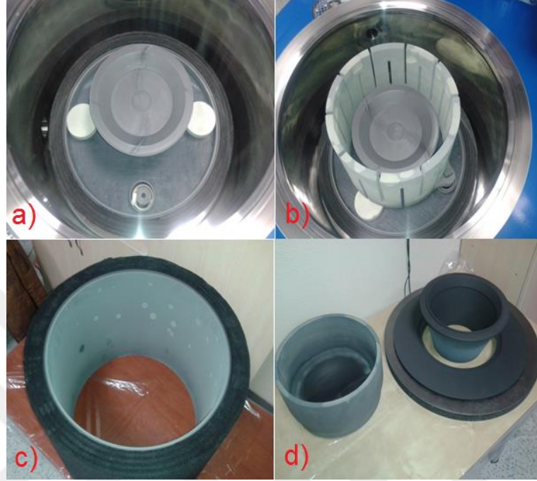
Şekil 3.7 Si şarj işlemi öncesi fırın bölgesi ekipmanının; a) Fırın bölgesi ve pota döndürme ve destek parçası, b) Fırın içi ısıtıcı ekipmanın bağlanması, c) Grafit izolasyon keçesi, d) Grafit pota haznesi, grafit koni ve fırın üstü ekipmanları (Kişisel arşiv, 2017)
