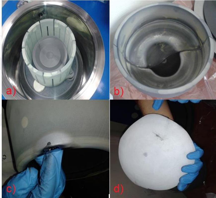
Şekil 4.4 Si ingot üretimi sonrası sıcak bölge ekipmanlarının görüntüleri; a) Isıtıcı elektrot, b) Destek grafit potası, c) Koruyucu huni, d) Deforme olmuş kuvars pota (Kişisel arşiv, 2017)
