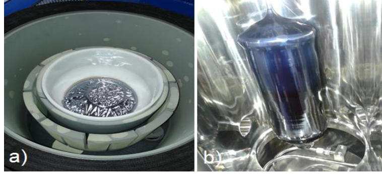
Şekil 3.14 Si ingot üretimi son ürünleri; a) Cz eritme bölgesinin görüntüsü, b) Kilit bölgesinin ve üretilen n-tipi tek kristalin Si ingotun görüntüsü (Kişisel arşiv, 2017)
