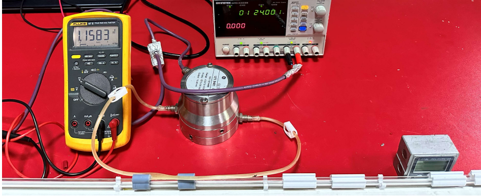
Şekil 19.Sensör doğrulama sistemi: Basınç ölçümü
