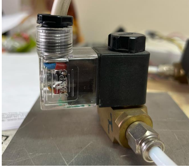
Şekil 9. Deney düzeneğinde kullanılan selenoid valf
