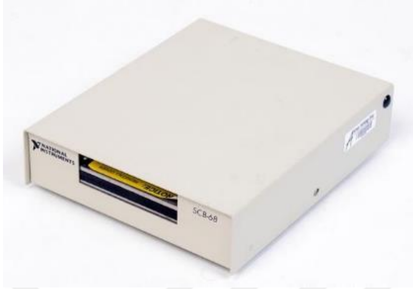
Şekil 13. Deney düzeneğinde kullanılan veri toplama kartı
