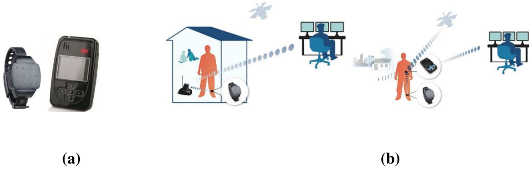
Şekil 2.4. (a) GPS takip ünitesi ve kelepçe, (b) İç ve dış sahada kullanımı
