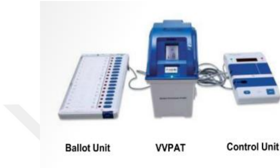
Resim 3: Hindistan Elektronik Oylama Makinelerinde bulunan Oy Birimi (BU), Seçmen Doğrulama Kağıt Denetim İzleri (VVPAT) ve Kontrol Birimi (CU)
