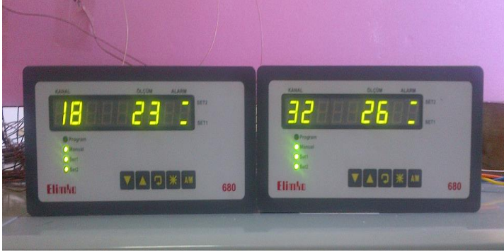
Şekil 3.13. ELİMKO-680 marka data logger
