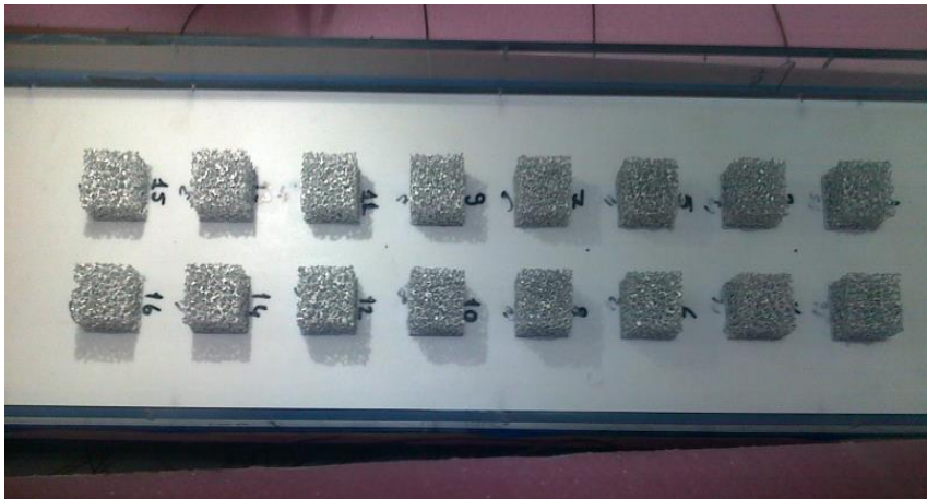
Şekil 3.5. Alüminyum köpük blokların kanal içine yerleşimi
