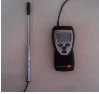
Şekil 3.12. TESTO-425 marka hız ölçer
