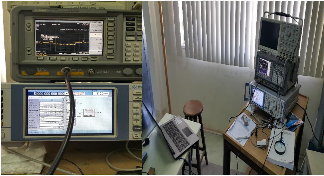
Şekil 3. 5. Ölçümde kullanılan spektrum analizör ve RF sinyal jeneratörü
