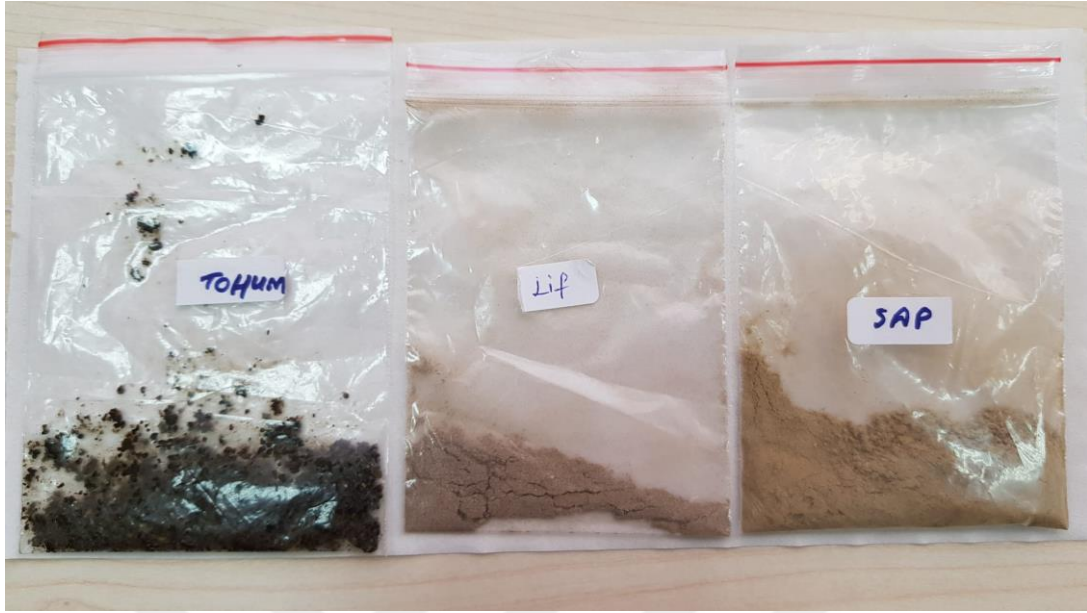
Şekil 3.2 a) Kenevir tohumu b) Kenevir lifi c) Kenevir sapının ball milling işleminden sonra toz haline getirilmiş görünümleri
