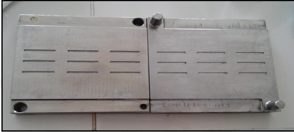
Şekil 3.5. Test numunesi hazırlamak için kullanılan metal kalıplar
