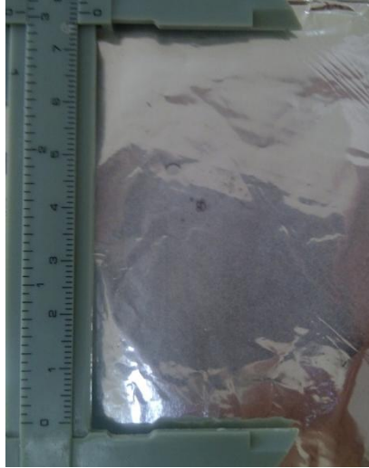
Şekil 5.3 PEO çözeltisine 20kV uygulanarak elde edilen fiber yapısı (R=8 cm)
