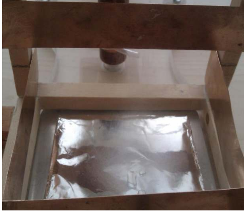
Şekil 5.16 Dörtlü paralel elektrot kullanılarak elde edilen fiber ağ yapısı. PEO çözeltisi, ( h_{paralel-1} = 6cm , h_{paralel-2} = 8cm g_{paralel} = 11cm ).
