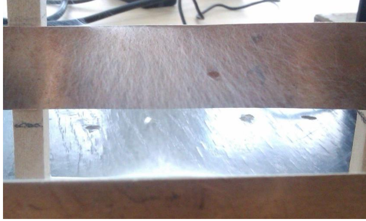
Şekil 5.14 İkili paralel elektrot ile PVA çözeltisi kullanılarak elde edilen fiber ağ yapısı. ( h_{paralel} = 5cm , g_{paralel} = 10cm )
