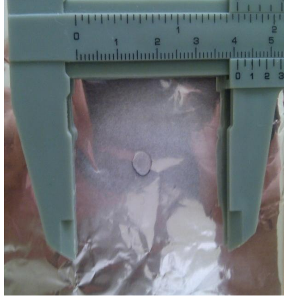
Şekil 5.9 Elektrostatik Eğirme ile elde edilen ağ yapısı, h=0.5 cm (PEO çözeltisi)
