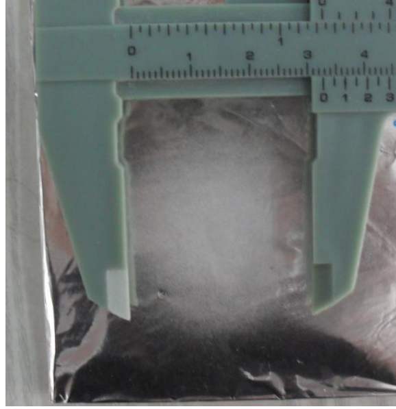
Şekil 5.6 Elektrostatik Eğirme ile elde edilen ağ yapısı. h=0.5 cm (PVA çözeltisi)
