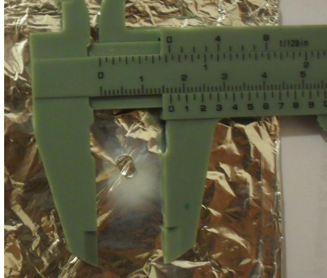
Şekil 5.11 İki silindirik elektrot kullanılarak oluşturulan Nano lif yapısı ( R = 1.5\text{cm} ), h_{birinci} = 0.5\text{cm} h_{ikinci} = 3.5\text{cm} V_1 = 12\text{kV} , V_2 = 6\text{kV} (PVA çözeltisi)
