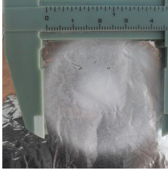
Şekil 5.8 Elektrostatik Eğirme ile elde edilen ağ yapısı, h=2.1 cm (PVA çözeltisi)
