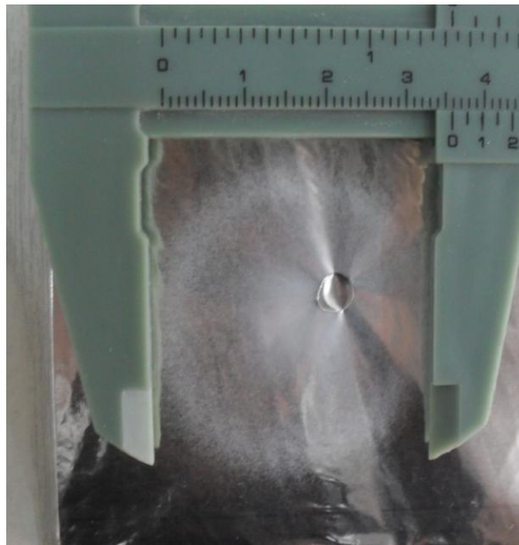
Şekil 5.7 Elektrostatik Eğirme ile elde edilen ağ yapısı. h=0.15cm (PVA çözeltisi)
