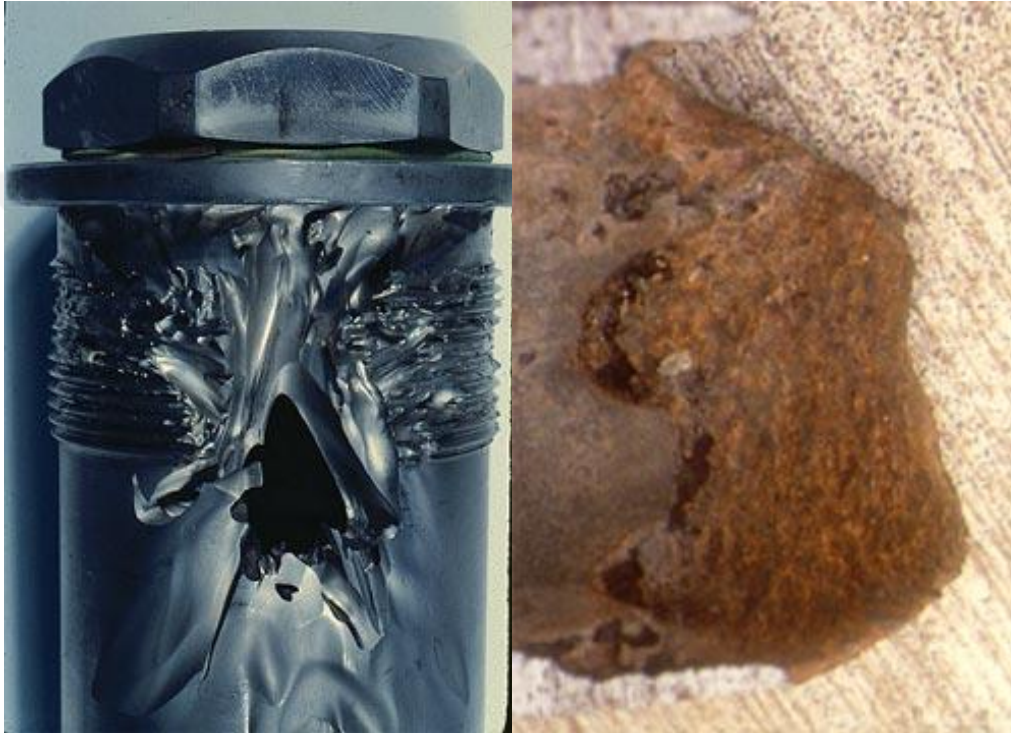
Şekil 2.13: Petrol sahası kontrol vanası ve iletim borusunda oluşan erozyon korozyonu (URL-7, 2024).
