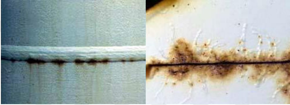
Şekil 2.11: Endüstriyel uygulamalarda filiform korozyon örnekleri (URL-7, 2024)
