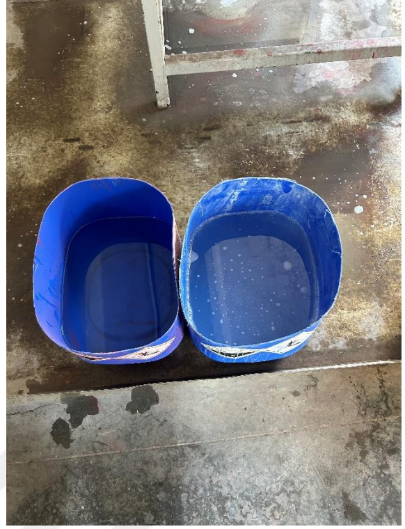
Şekil 4.6: Yağ alma ve zirkonyum nano kaplama banyosu
