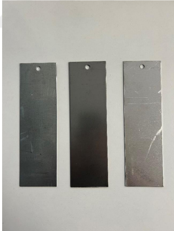
Şekil 4.3: Deneysel çalışma yapılacak numuneler 1) Pregalveniz 2) DKP 3) Alüminyum
