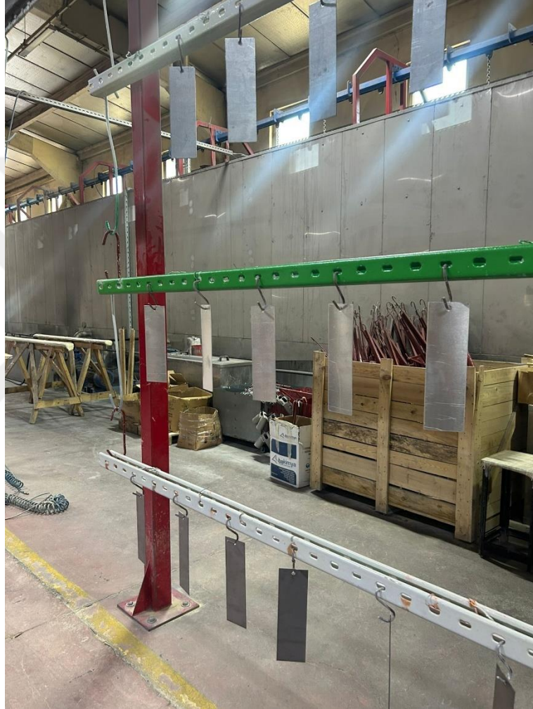
Şekil 4.4: Konveyör bandına asılan deney numuneleri
