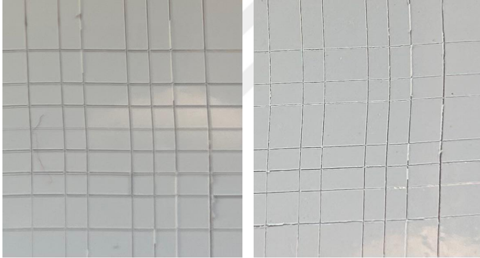
Şekil 5.3: a) Demir Fosfat kaplı pregalvaniz numune b) Zirkonyum kaplı pregalvaniz numune
