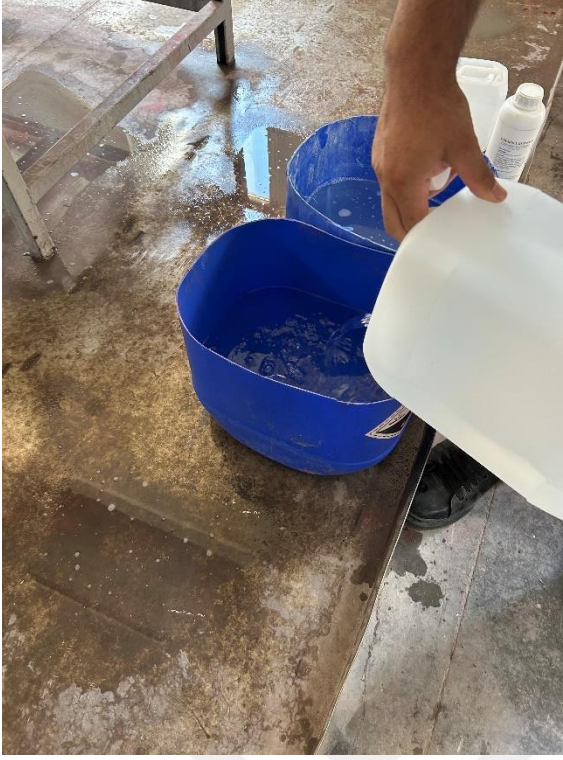
Şekil 4.6: Yağ alma ve zirkonyum nano kaplama banyosu
