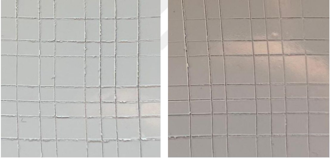
Şekil 5.1: a) Demir Fosfat kaplı alüminyum numune b) Zirkonyum kaplı alüminyum numune
