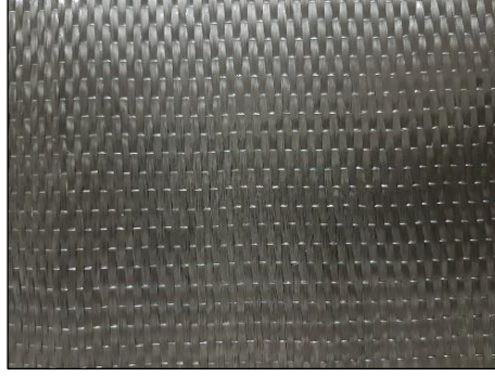
Şekil 3.10. Tek yönlü 300 gr ağırlıklı karbon elyaf kumaş.
