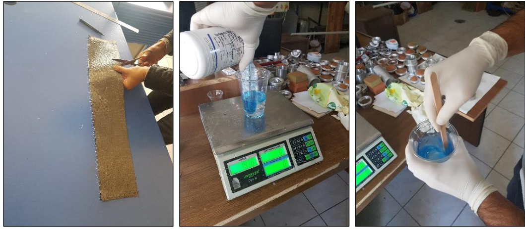
Şekil 3.14. Elyafın kesilmesi, epoksi harcın belirli oranlarda karıştırılması.
