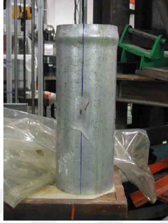
Şekil 2.1. Lokal burkulmaya uğramış kolon [43].
