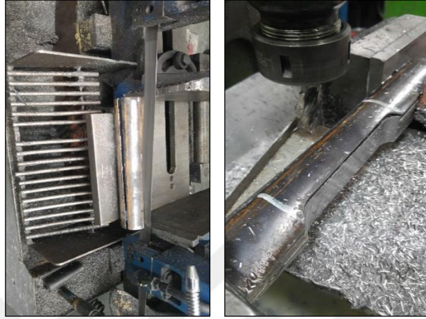
řekil 3.1. Kolonun kesilerek ekme numunesinin hazırlanması.
