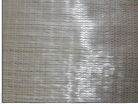
Şekil 3.9. Tek yönlü 330 gr ağırlıklı cam elyaf kumaş.
