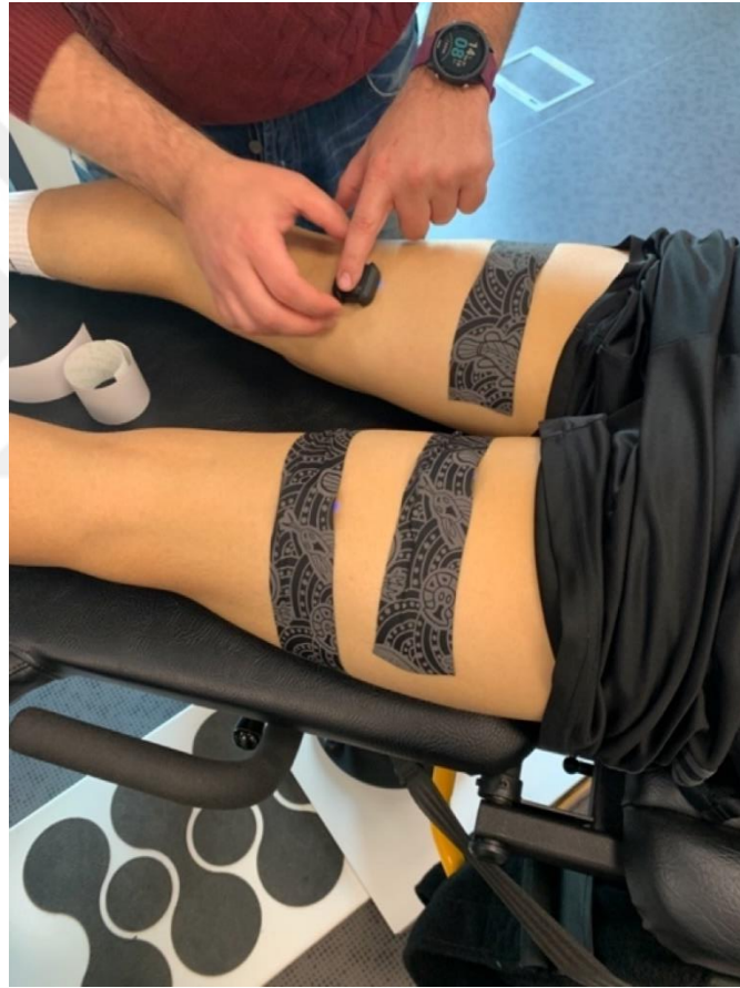
Şekil 3.2. İzokinetik kas kuvvet testi hemen öncesinde kablosuz y-EMG sensörlerinin her iki alt ekstremitede yerleşimi ve sabitlenmesi
