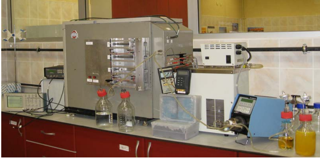
Şekil 3.1. Deneylerde kullanılan laboratuvar ölçekli PEF sistemi.
