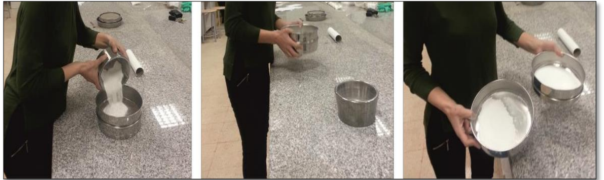
Şekil 3.17. Öğütülmüş numunelerin eleme işlemleri
