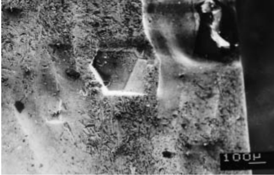
Şekil 4.2. Kopan elmas tanesi çevresindeki aşınma bölgesi.
