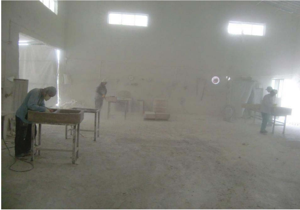
Şekil 3.20 Önlem alınmamış havalandırması yetersiz mermer atölyesi
