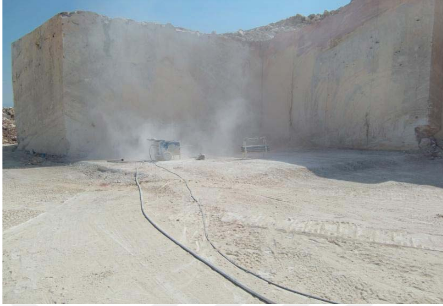
Şekil 3.1 Elmas tel kesme yöntemi ile mermer blok üretimi
