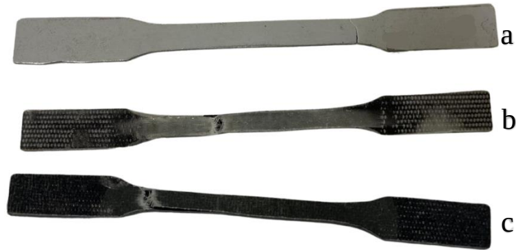
Resim 4.5 Alüminyum Kompozit Panellerin Çekme Testi sonrası görüntüleri
