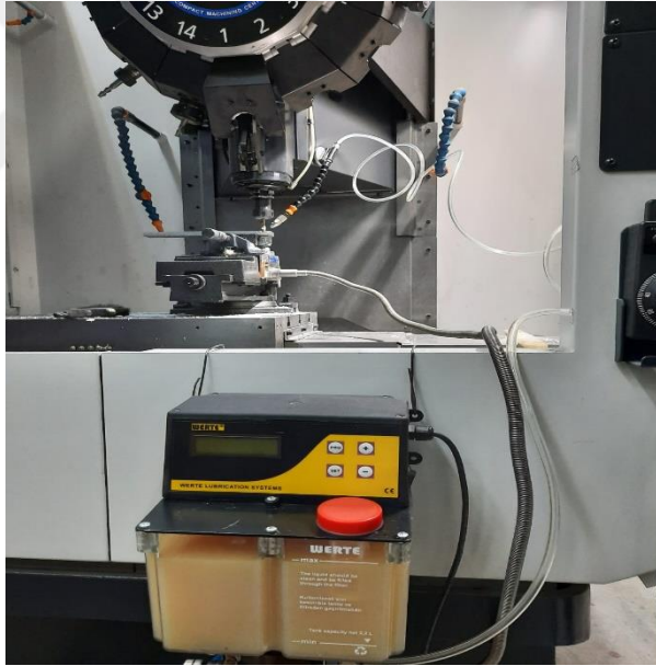
Şekil 3.3. MMY-kesme sıvısı ortamında yapılan deney
