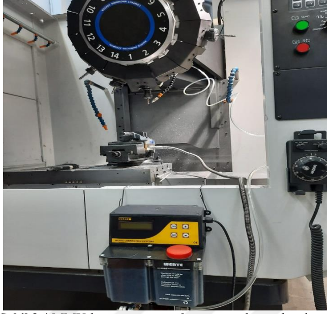
Şekil 3.4.MMY-kesme sıvısı-grafen ortamında yapılan deney
