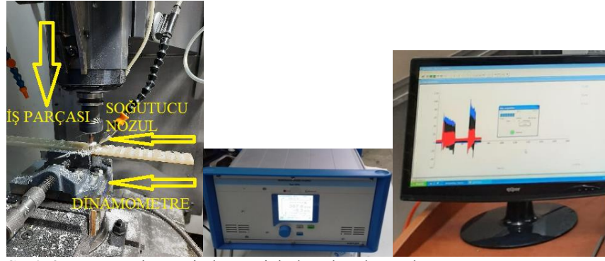
Şekil 3.7. Kesme kuvveti ölçümü için kurulan düzenek
