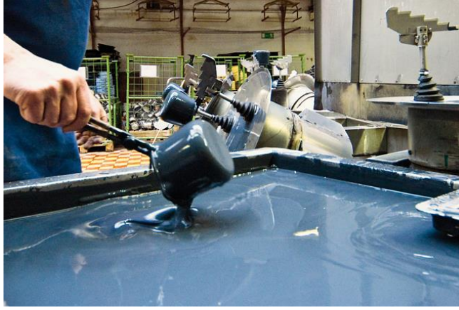
Şekil 2.15. Astar emayenin daldırma yöntemi ile kaplanması
