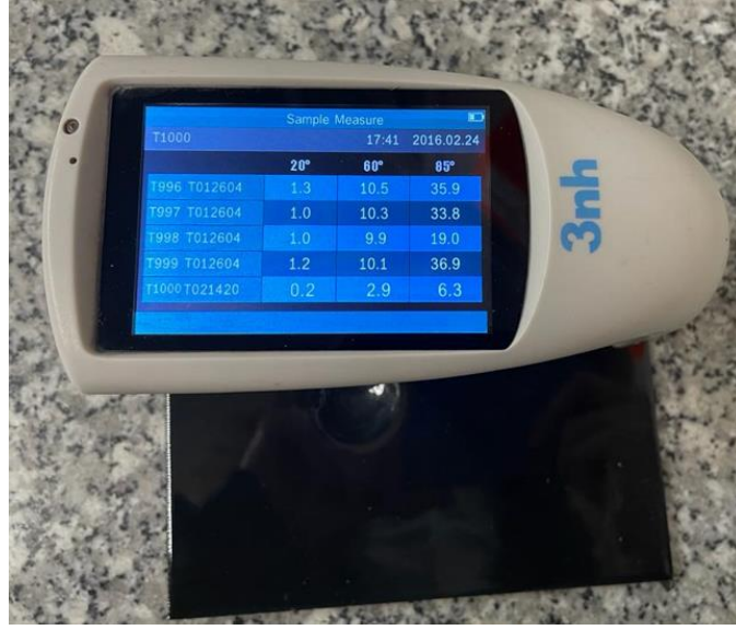
Şekil 3.6. Yüzey parlaklığı ölçüm cihazı ve ölçüm yöntemi (glossmetre) (Algotrio Kimya 2022)
