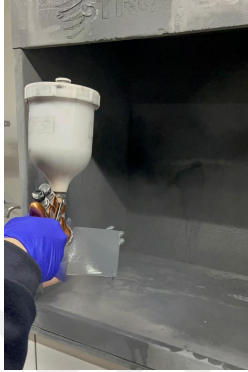
Şekil 2.8. Manuel sprey yöntemi ile uygulama (Algotrio – 2022)
