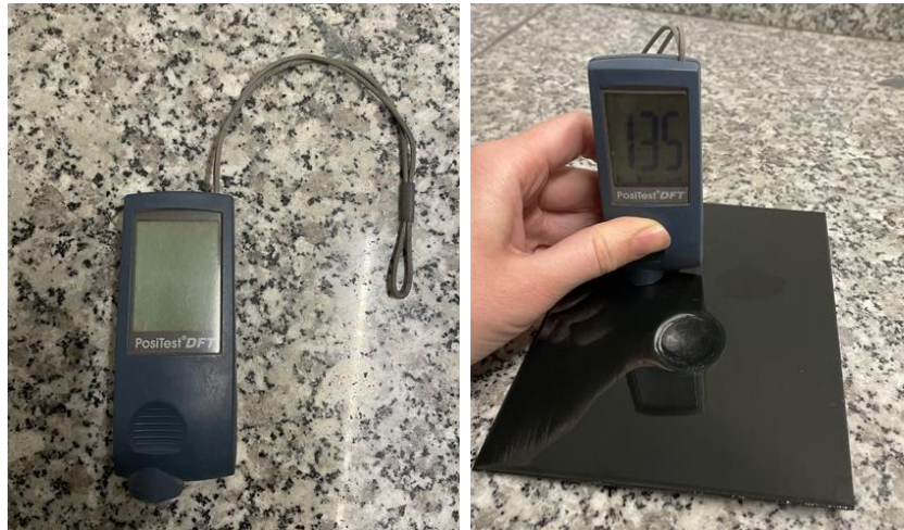
Şekil 3.3. Kaplama kalınlığı ölçüm cihazı ve ölçüm yöntemi (Algortrio Kimya 2022)
