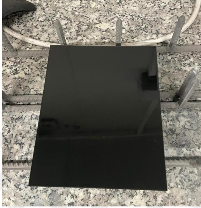
Şekil 5.5. Astar emaye kaplanmış plaka numunesi (Algotrio Kimya 2022)
