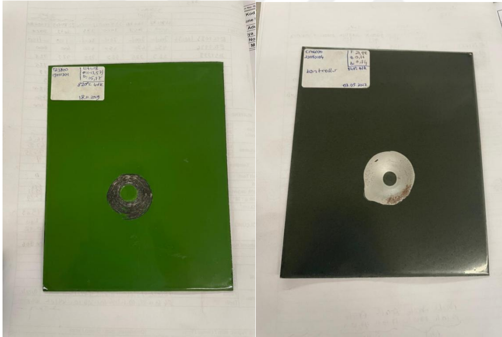
Şekil 3.2. Yapışma Değeri 1 (Sol) ve 4 Olan (Sağ) Emaye Kaplama Görseli (Algotrio Kimya 2022)
