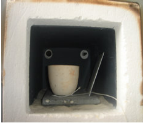
Şekil 6.4 Emaye ve krozenin fırına şarj görüntüsü.
