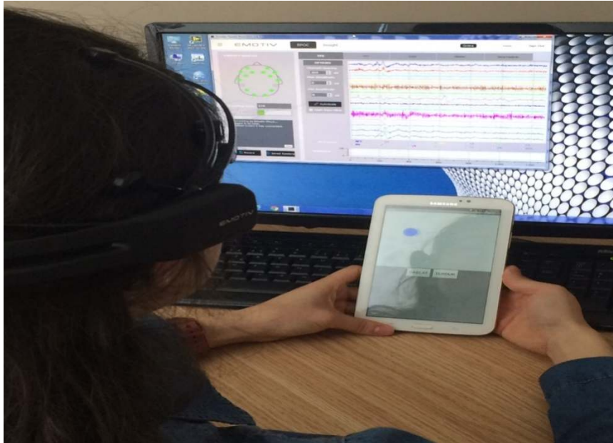
Resim 4.2 Emotiv EPOC EEG cihazıyla alınan ölçüm düzeneği.
