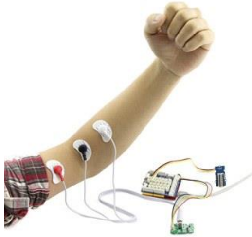
Resim 3.19 Yüzey elektrotunu göstermektedir (İnt.Kyn.7).
