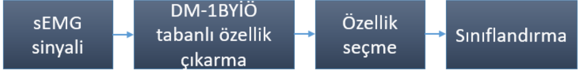
Şekil 5.1 Önerilen otomatik sEMG sinyali sınıflandırma yöntemi.
