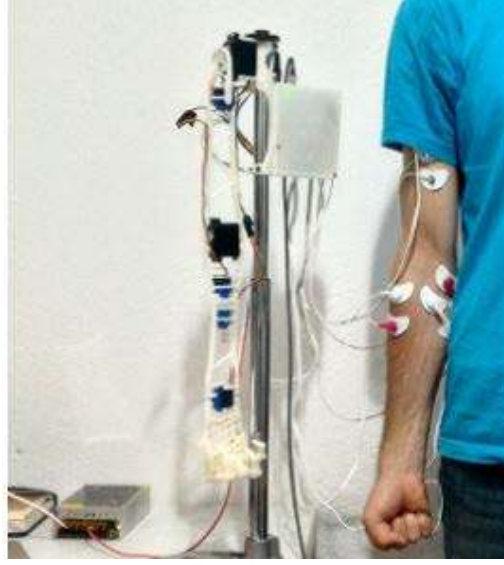
Şekil 4.27 El Açma-Kapama hareketi deneyi.
