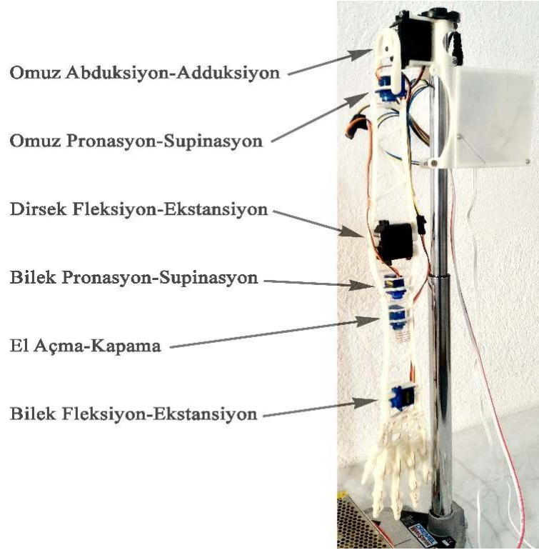
Şekil 4.20 Robot kol eklemlerini kontrol eden aktüatörler.
