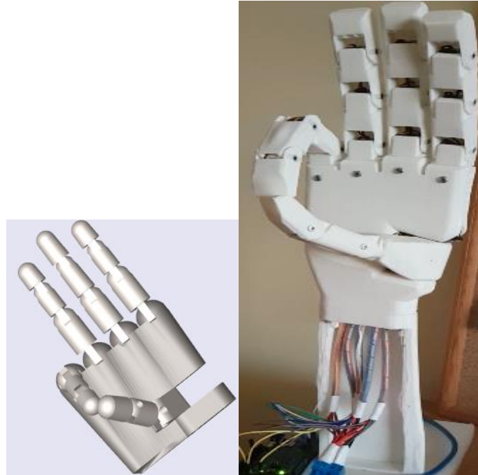
Şekil 11.34. Simülasyon ve protez el prototipinin baş-ışaret parmak teması hareketi görüntüsü
