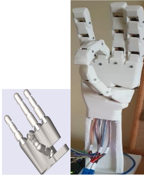
Şekil 11.32. Simülasyon ve protez el prototipinin baş-yüzük parmak teması hareketi görüntüsü
