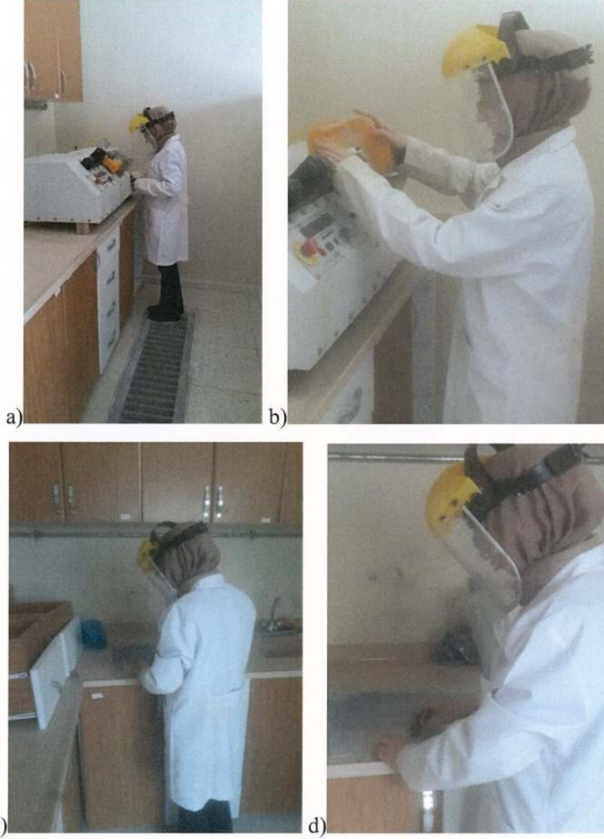
Şekil 1.2 Kayaç örneğinin elmas diskle kesim aşaması (a,b); Hazırlanan kesitin cam üzerinde silisyum karbür kullanılarak aşındırılması (c,d).
