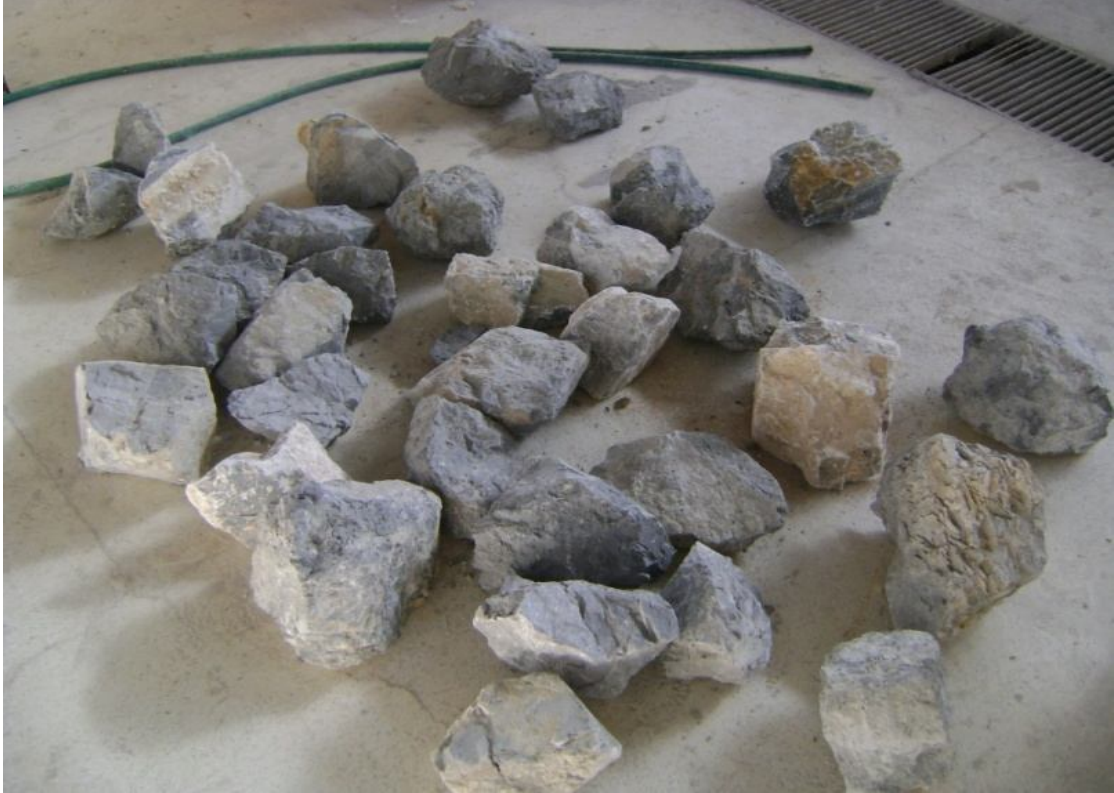
Resim 3.3 Ocaktan alınan iri boyutlu numuneler.
