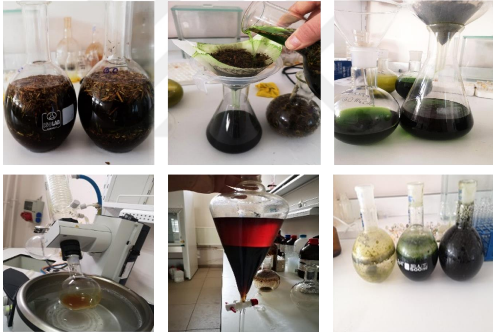
Şekil 3. 2. Glaucium cappadocicum bitkisi için ekstraksiyon işlemleri
