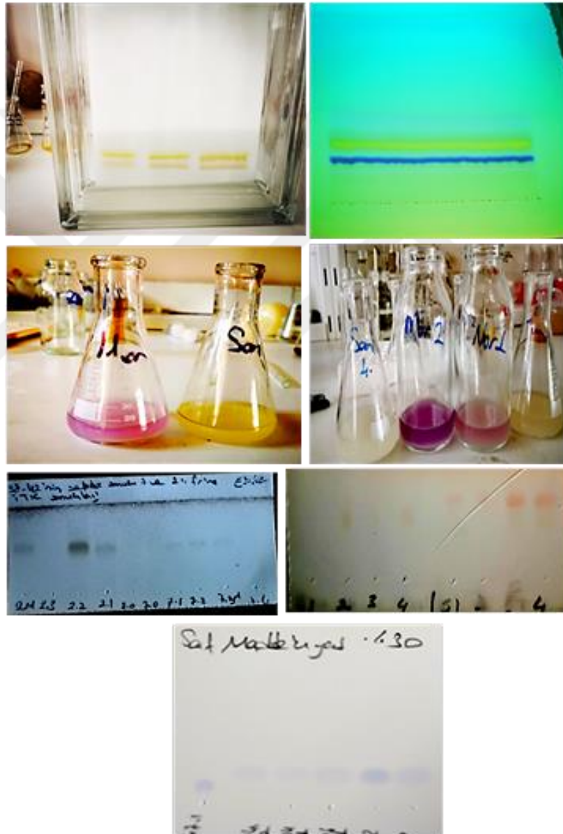
Şekil 4. 13. Preparatif İTK ile alkaloid izolasyon çalışmaları
